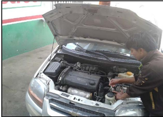
**Figura 2.6: Cambio de batería**
