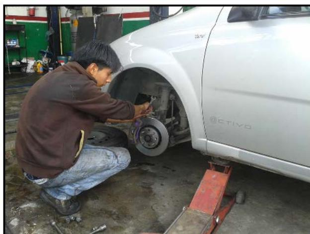
**Figura 2.7: Cambio de pastillas de freno**
