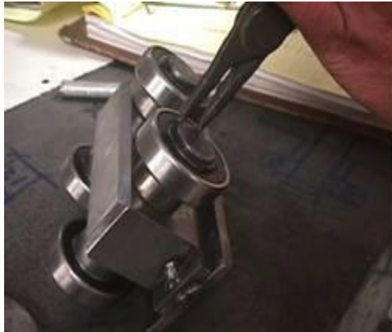
Figura 4.25 Colocación de anillo de seguridad
