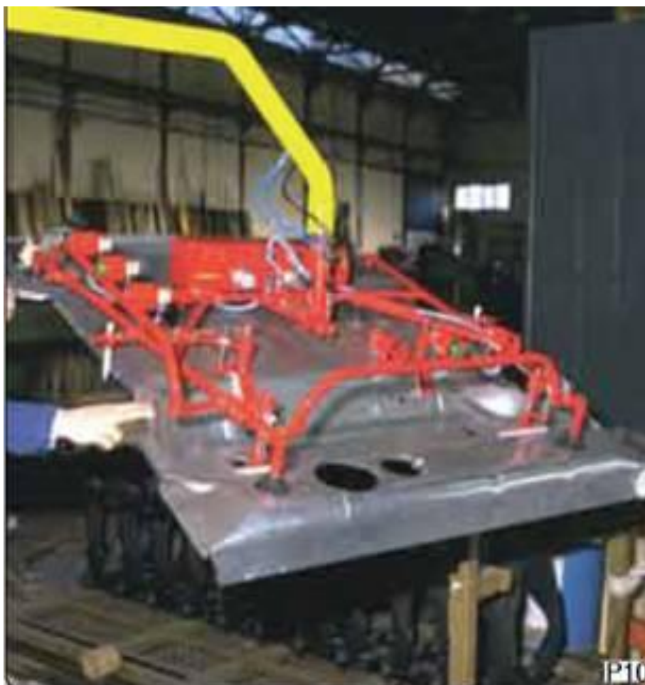
*Figura 1.8 Manipulador tipo ventosa para manipular planchas de acero
