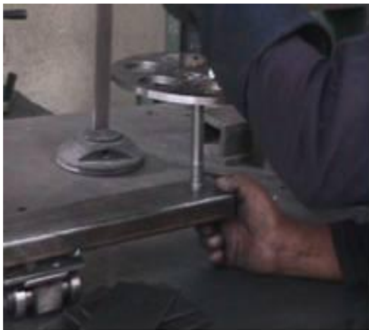
Figura 4.16 Colocación de discos en eje
