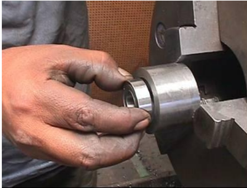
Figura 4.7 Maquinado de alojamiento rodamientos
