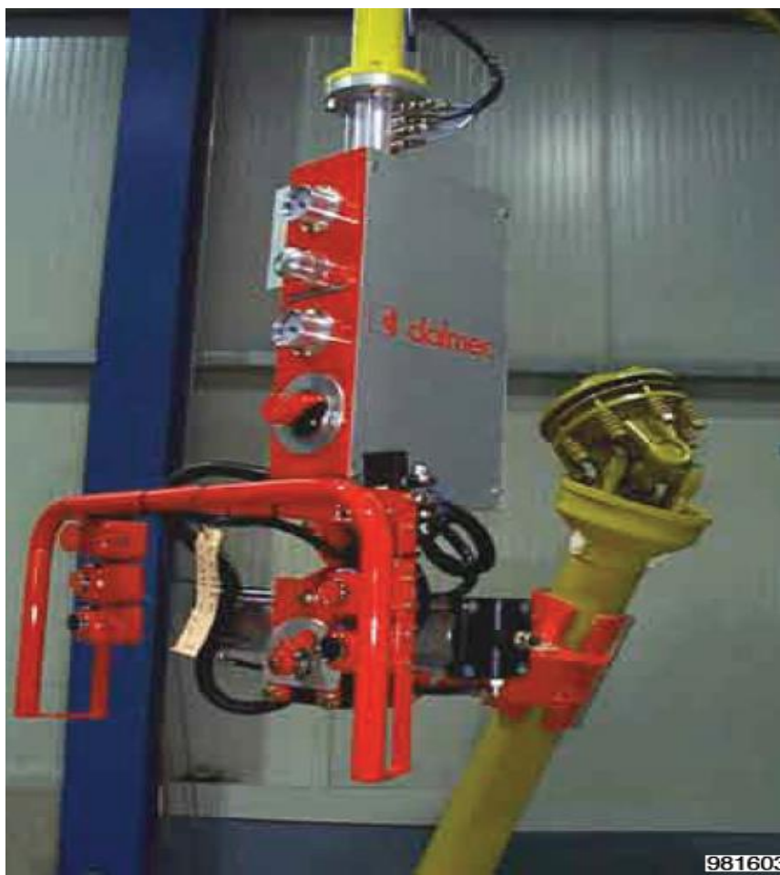
*Figura 1.6 Manipulador tipo pinza para transmisiones.
