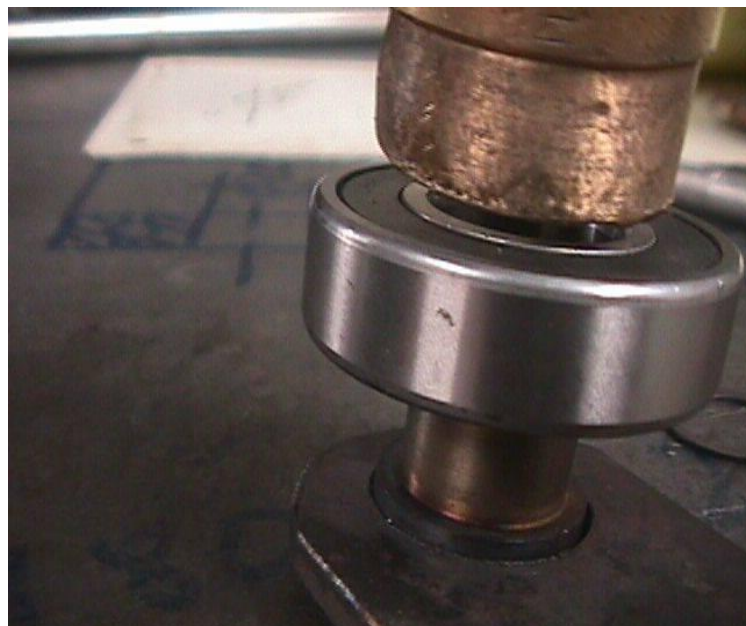
Figura 4.24 Colocación de rodamientos
