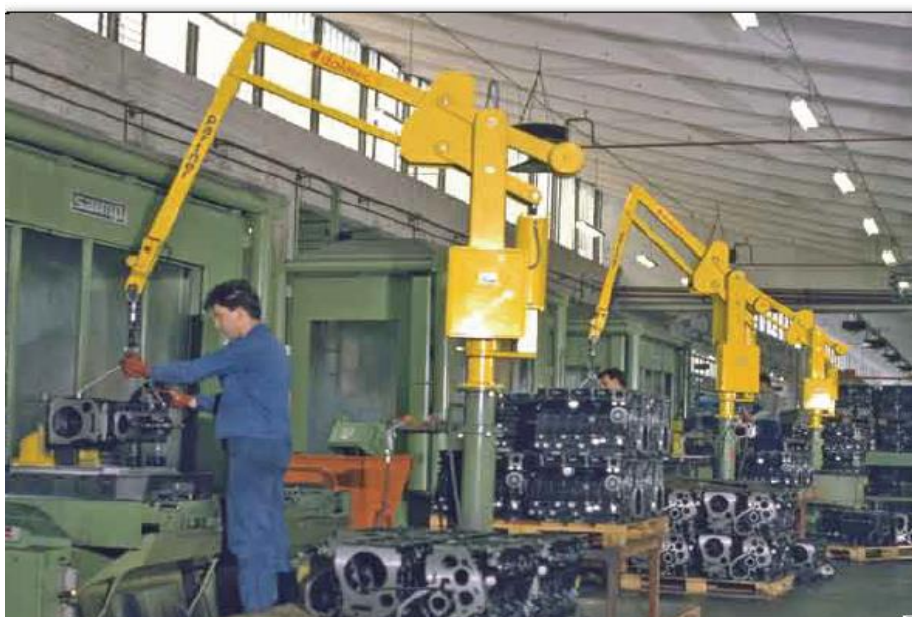
*Figura 1.7 Manipulador tipo gancho para bloques de motor
