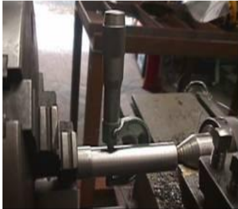
Figura 4.19 Medidas de eje rodamientos vehículo
