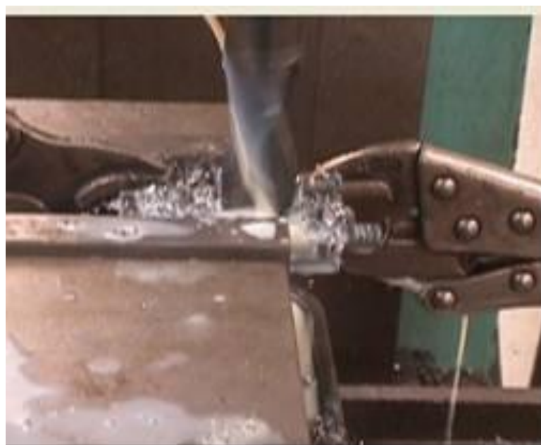
Figura 4.20 Perforación de bloque de acero
