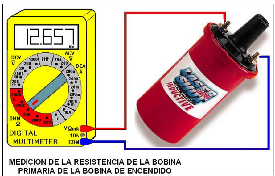
Figura 1.40 Medición de resistencia del circuito primario (bobina).
