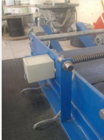
Figura 4.18. Colocación Contador de Metros y Fines de Carrera
