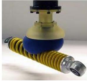
Figura 2.20: Robot con lijadora como herramienta terminal [9]
