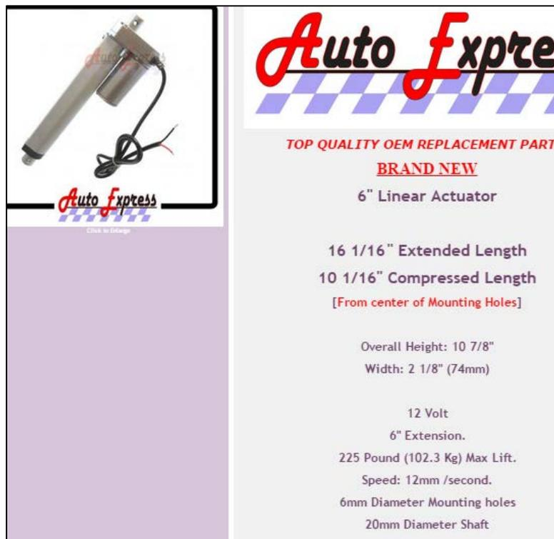
Figura 3.17: Datos mecánicos del pistón [22]
