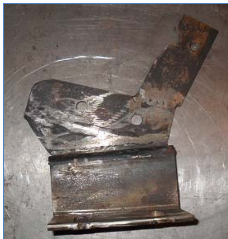
Foto No. 3.3 Construcción de la base del motor
