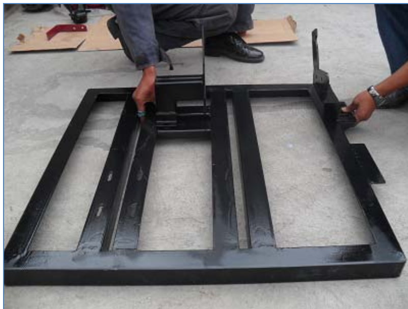
Foto No. 3.1 Elaboración de la base del banco de pruebas
