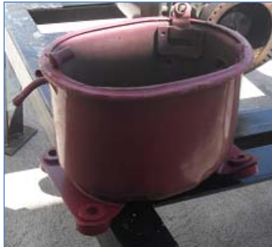
Foto No. 3.19 Depósito de aceite
