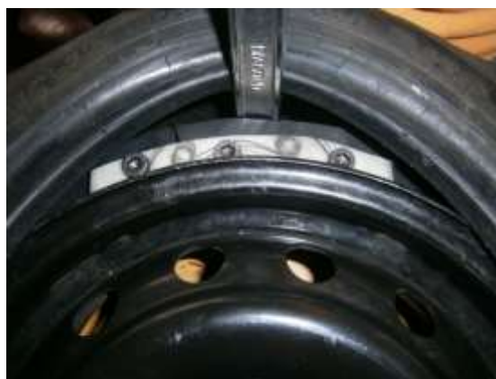
Figura 4.23 Colocación de las platinas de duralón y los pernos Allen M10
