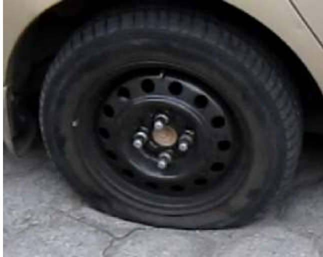
Figura 5.5 Neumático sin el sistema después de recorrerlo 5Km. pinchado
