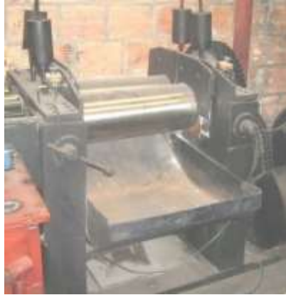
Figura 4.5 Molino de dos rodillos
