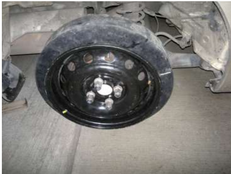
Figura 5.1 S.E.R. Montado en el vehículo sin el neumático
