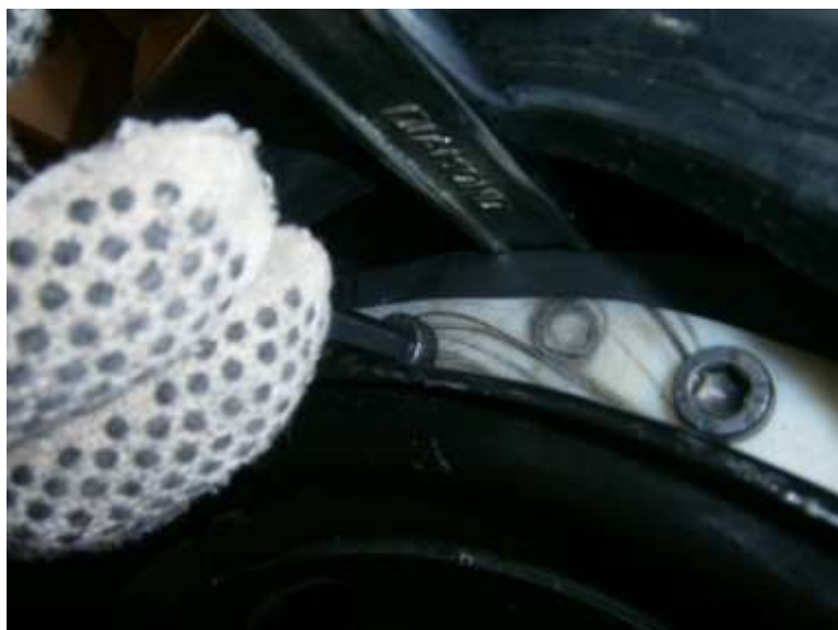
Figura 4.13 Ajuste del anillo mediante el mecanismo de sujeción y los pernos
