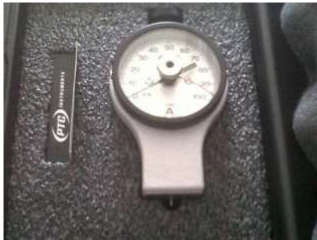
Figura 4.9 Durómetro shore tipo A
