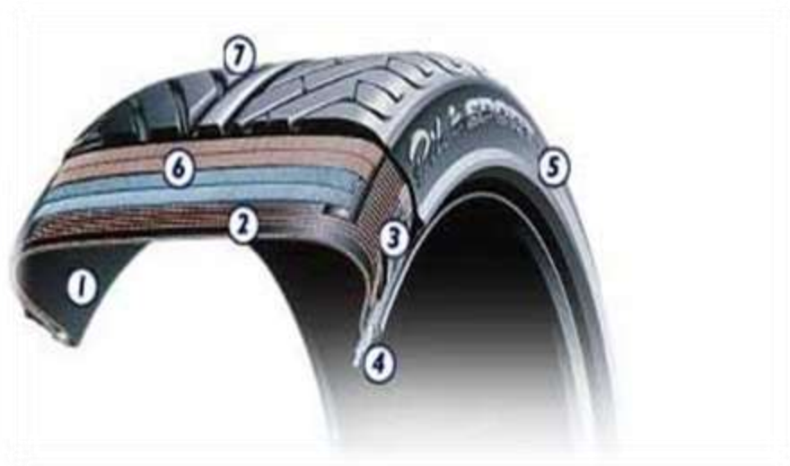
Figura 2.2 Composición del neumático 7
