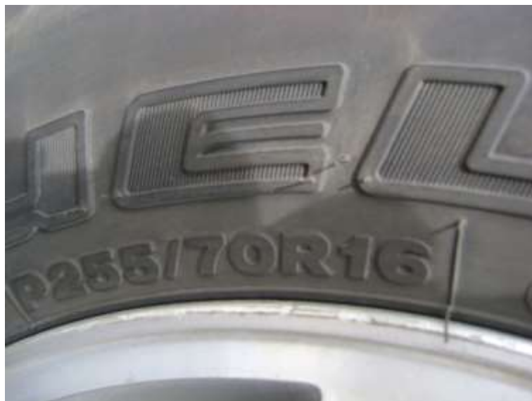
Figura 2.3 Dimensiones del neumático
