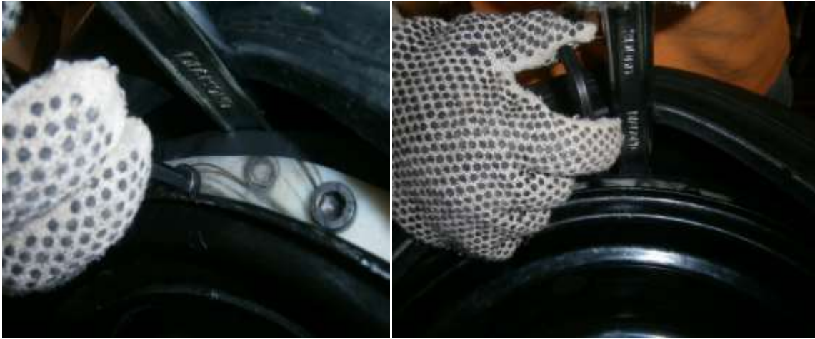
Figura 4.24 Ajuste de los pernos Allen M10
