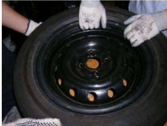
Figura 4.22 Verificación de la posición de la válvula con respecto al anillo.
