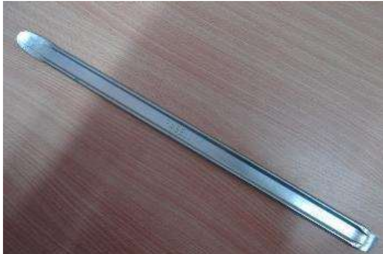
Figura 4.15 Palanca para desmontar neumáticos
