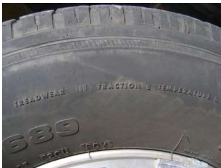
Figura 2.6 Inscripciones de los parámetros de la UTQG en el neumático
