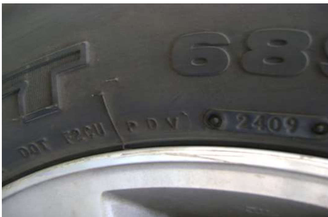
Figura 2.5 Inscripciones de año de fabricación y DOT en un Neumático
