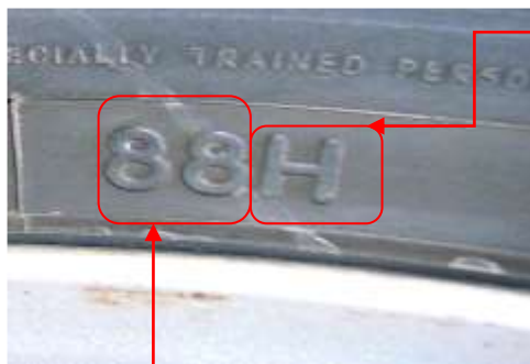
Figura 2.4 (Codificación, Rango de velocidad y carga)
