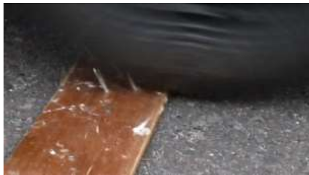
Figura 5.3 Neumático pasando sobre la tabla con clavos a 50 km/h
