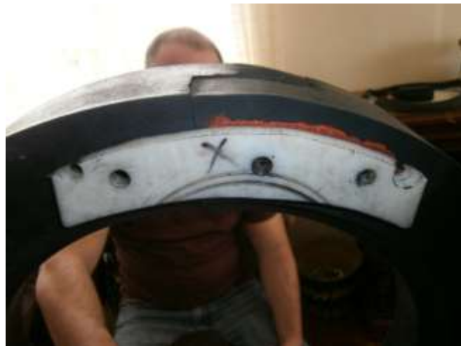
Figura 4.12 Plancha de duralon inferior maquinada y adherida en el sistema.
