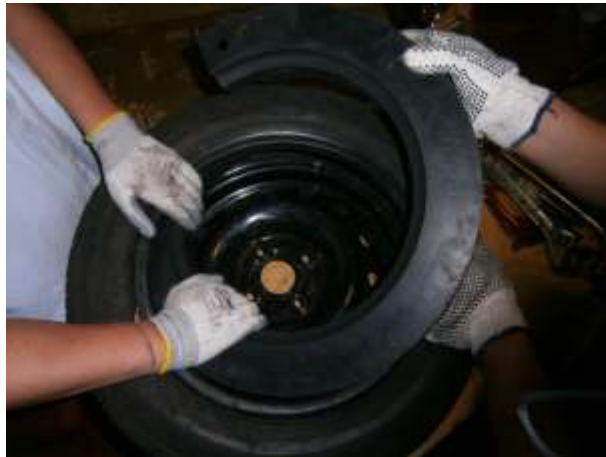
Figura 4.20 Inicio de introducción de banda de polisopreno.
