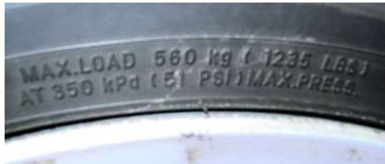
Figura 2.8 Inscripción de inflado y carga máxima de un neumático
