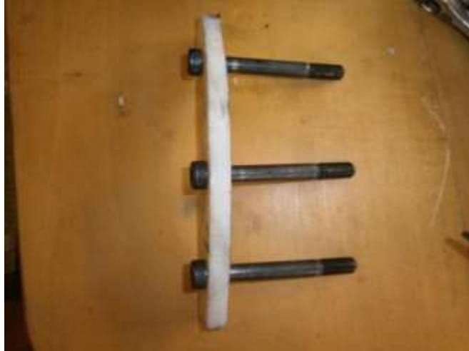
Figura 4.11 Pernos Allen M10 de 75mm. Y plancha superior de duralón.
