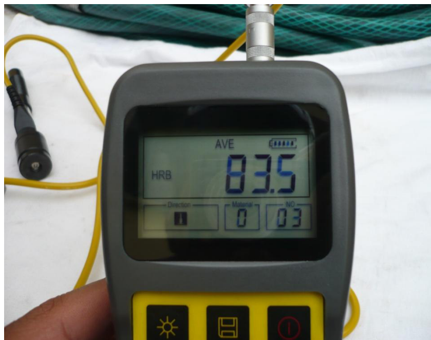
Fig. 3.11 Promedio #1 de Dureza Rockwell
