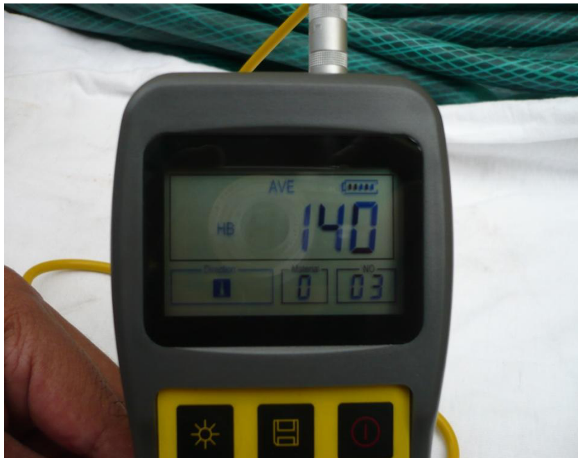
Fig. 3.4 Promedio #1 de Dureza Brinell
