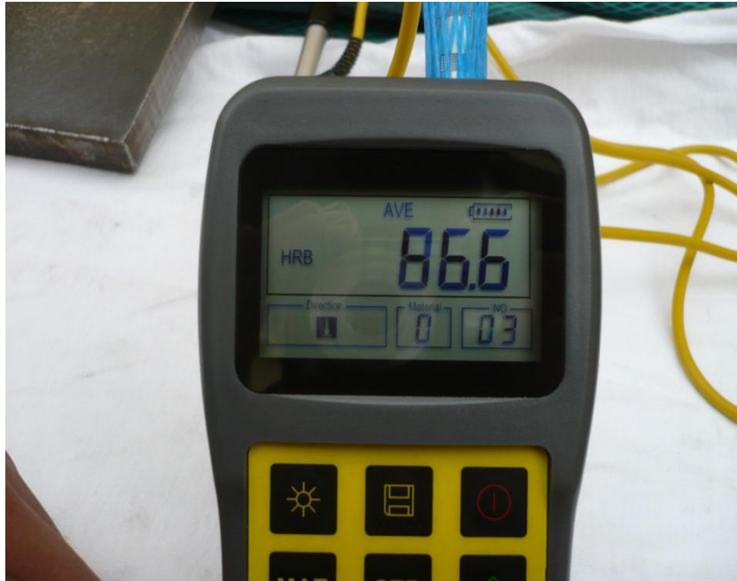
Fig. 3.12 Promedio #2 de Dureza Rockwell
