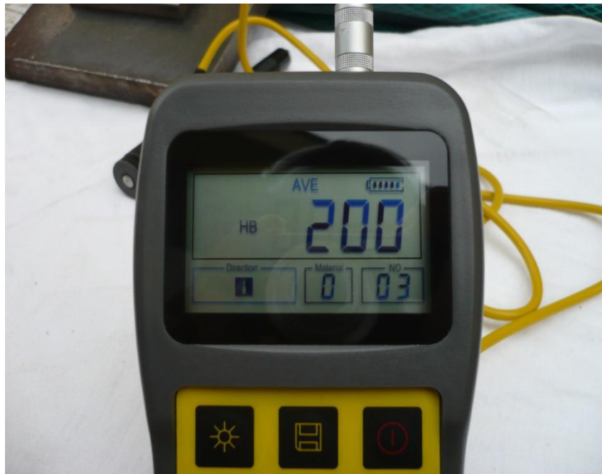
Fig. 3.6 Promedio #3 de Dureza Brinell
