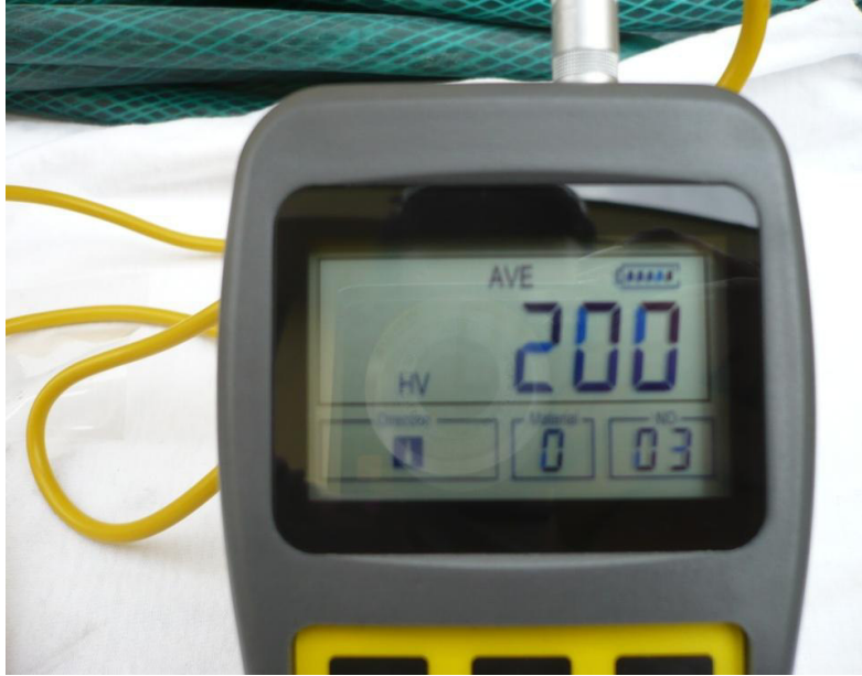
Fig. 3.8 Promedio de Dureza Vickers
