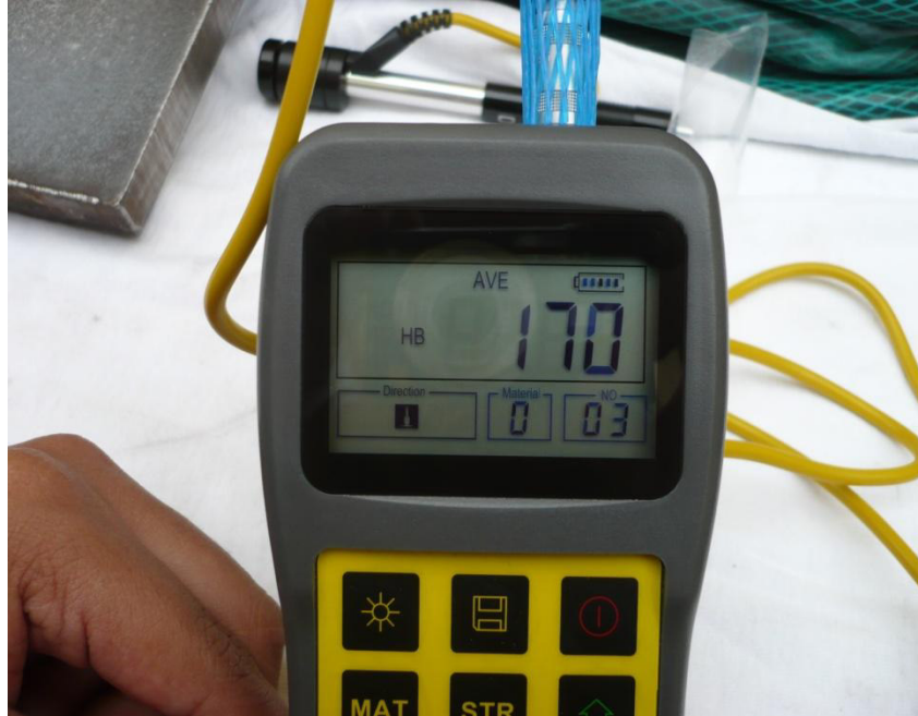
Fig. 3.5 Promedio #2 de Dureza Brinell
