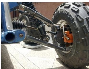
**Figura 3.12:** Suspensión independiente McPherson posterior y delantera
