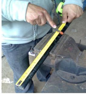
**Figura 2. 3** Marcación de un tubo
