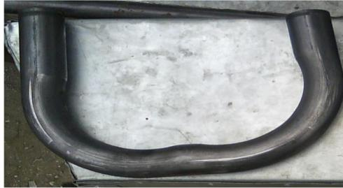
**Figura 2. 6** Doblado de tubos por presión
