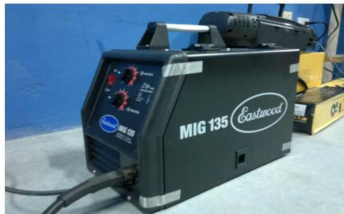
**Figura 2. 7** Máquina de soldadura (MIG)
