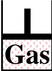
Fig.2.7 ejemplo de proceso Isobárico.<sup>18</sup>
