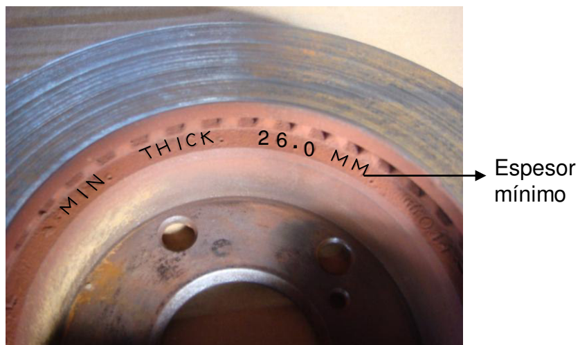
Figura 4.2: Grosor mínimo del disco.
