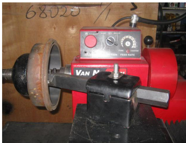
Figura 4.40: Proceso de maquinar cejas.
