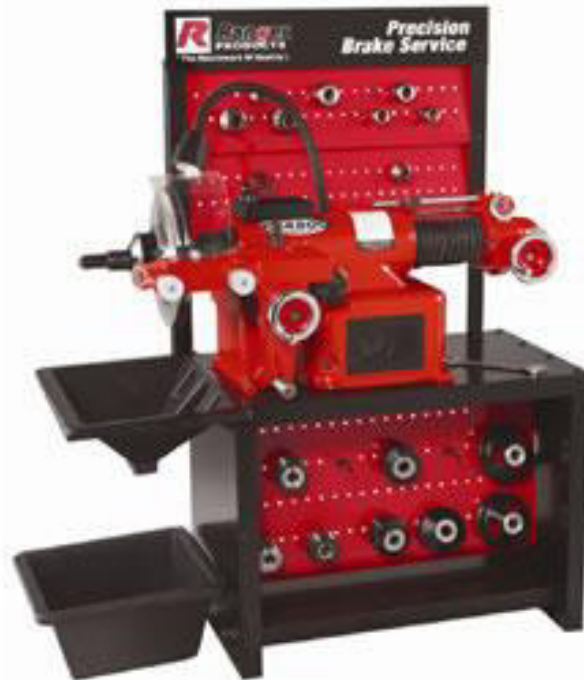
Figura 1.1: Rectificadora de discos y tambores.
