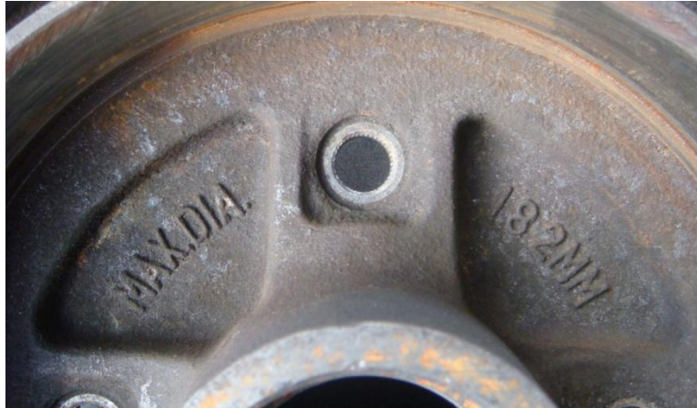
Figura 3.5: Grabado del diámetro máximo de un tambor.
