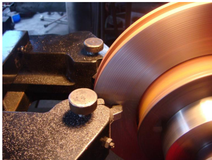
Figura 4.20: Operación de cepillado.
