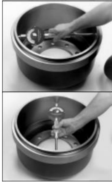
Figura 4.43: Medición del nuevo diámetro
