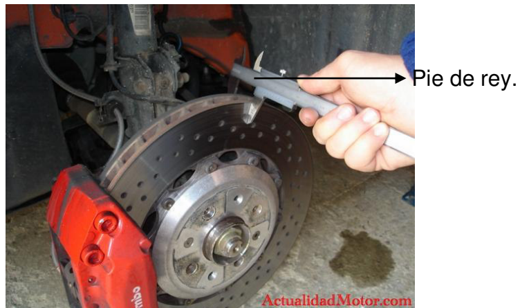
Figura 4.22: Medición del nuevo espesor.
