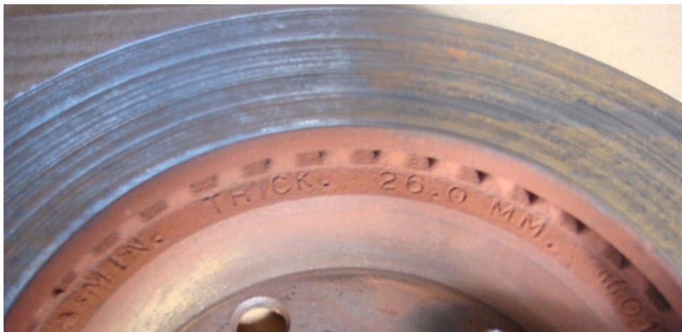
Figura 3.6: Grabado del grosor mínimo de un disco.
