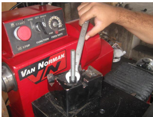
Figura 4.36: Ajuste de la parte inferior del soporte de sujeción.
