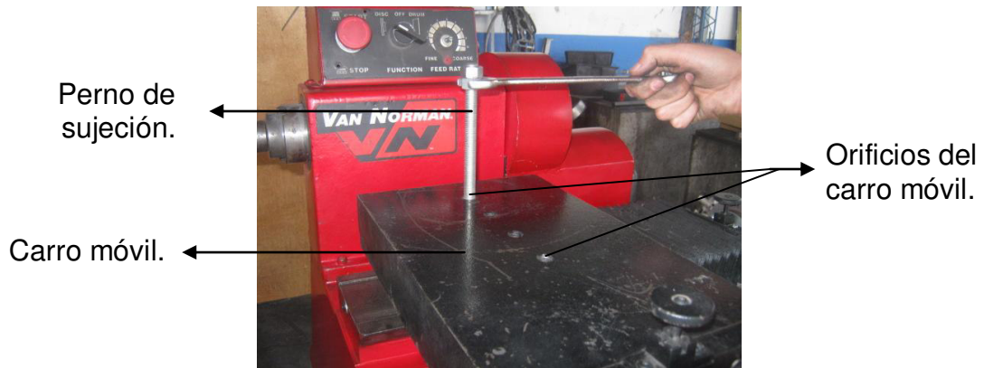
Figura 4.11: Ajuste de perno de sujeción.
