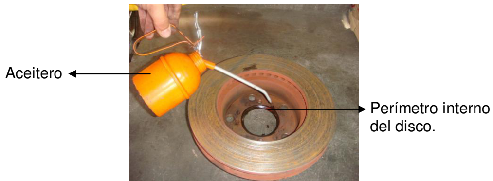
Figura 4.4: Perímetro interno del disco aceitado.
