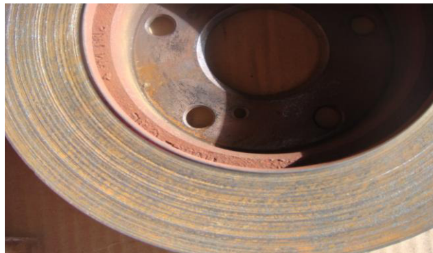
Figura 4.3: Superficie de disco dañada.
