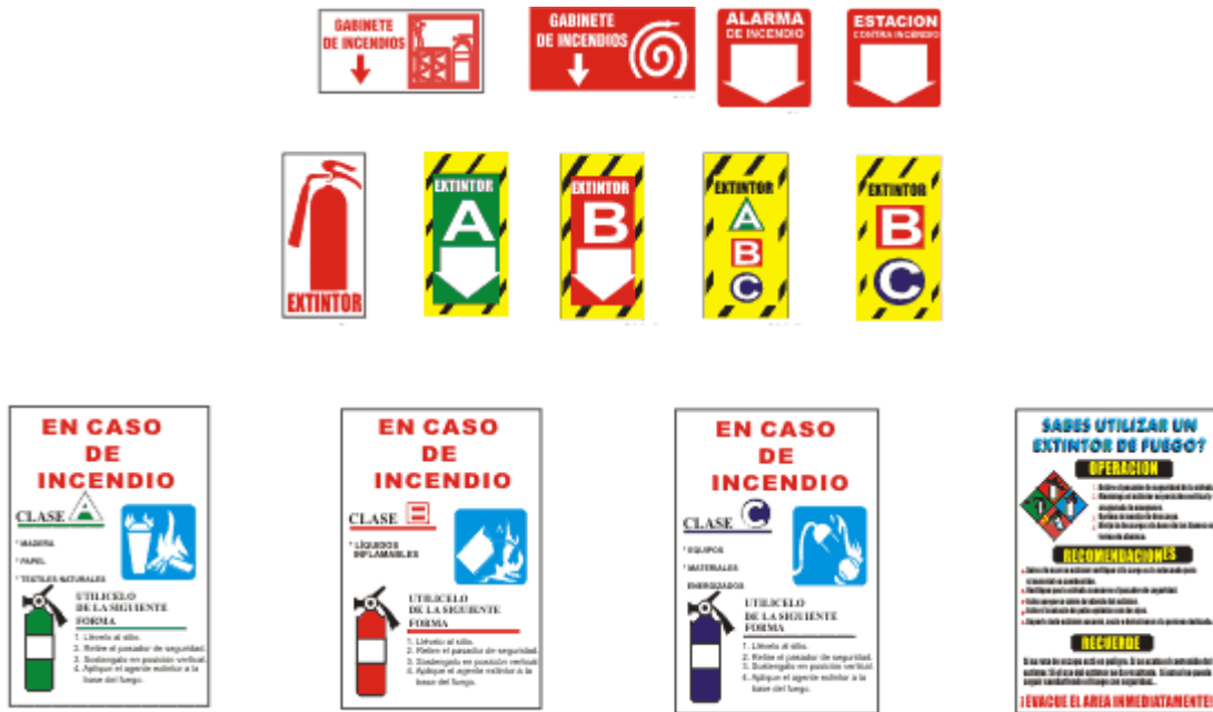
Figura 4.6 Señales Contra Incendios 29
