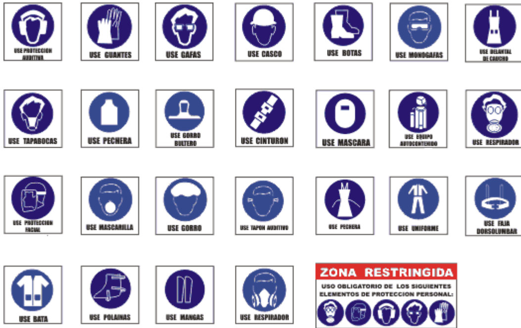
Figura 4.7 Señales de elementos de protección personal 30
