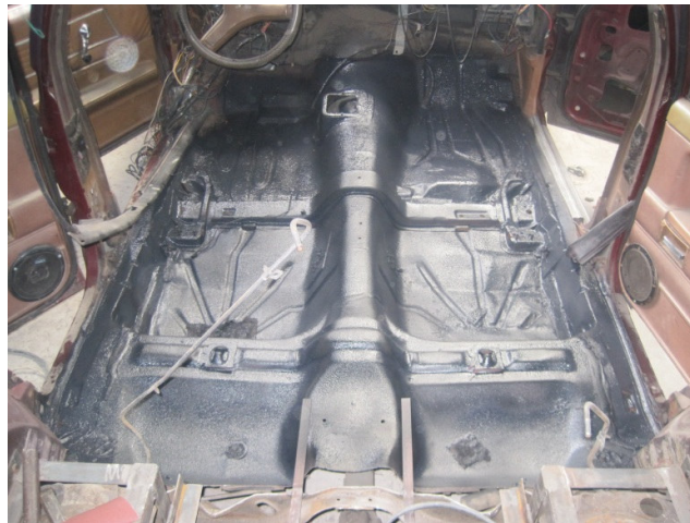
Figura 4.25. Piso Original aplicado recubrimiento.
