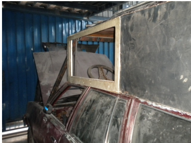
Figura 4.52. Colocación de Ventanas Laterales.
