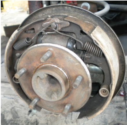
Figura 2.8. Freno de Tambor Reparado
