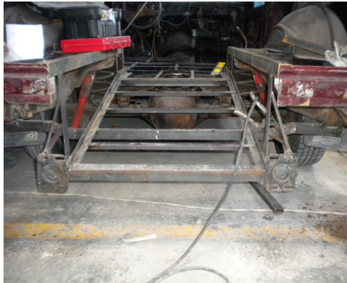
Figura 4.12. Estructura Plataforma Fija
