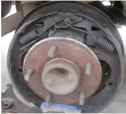
Figura 2.7. Freno de Tambor con fuga de Líquido
