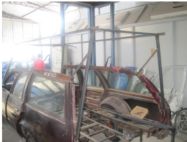
Figura 4.17. Estructura Techo Parte Posterior
