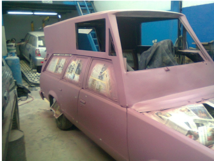
Figura 4.57. Aplicación de fondo automotriz.
