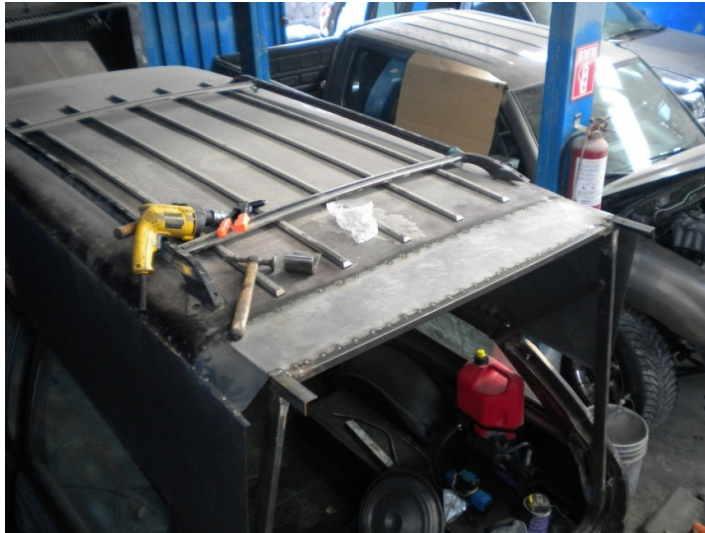
Figura 4.49. Pieza extendida para Nuevo Techo.
