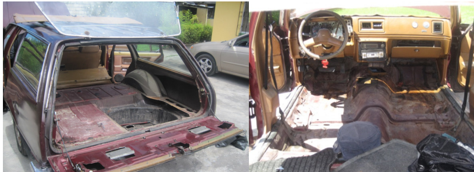
Figura 4.3. Desmontaje Accesorios parte Interna
