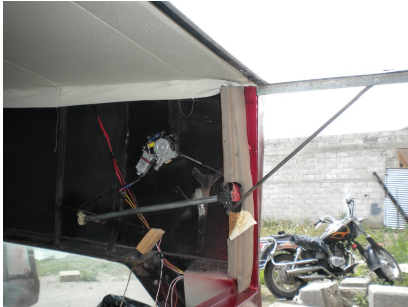
Figura 4.55. Instalación de eleva-vidrio
