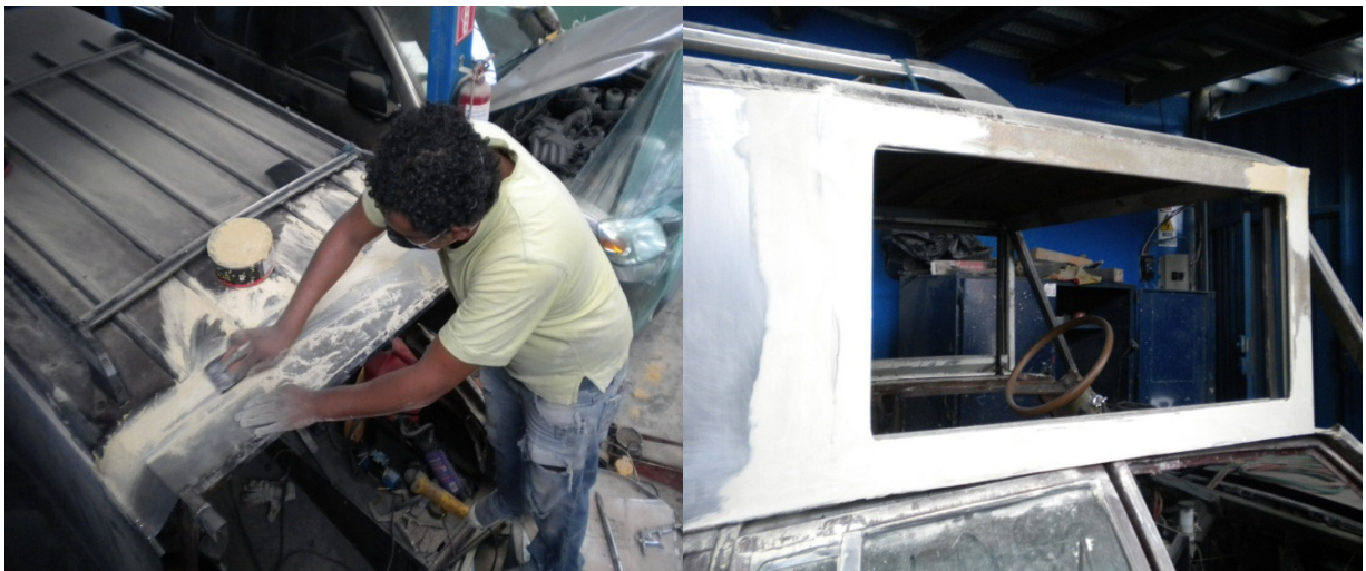
Figura 4.56. Aplicación de masilla automotriz.
