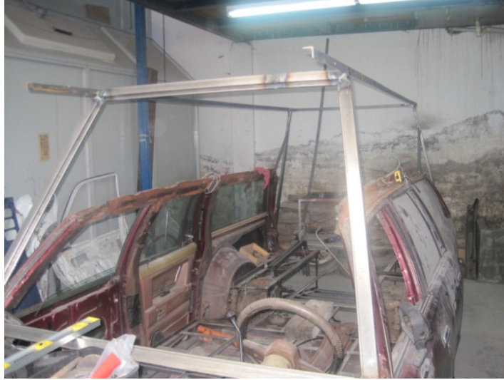
Figura 4.16. Estructura Techo y Marco Parabrisas Delantero
