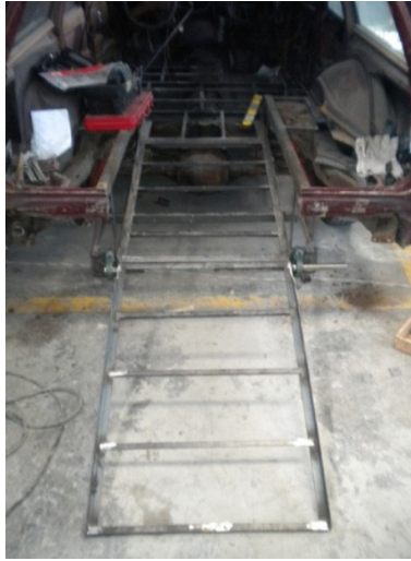
Figura 4.14. Estructura Plataforma Móvil y Fija
