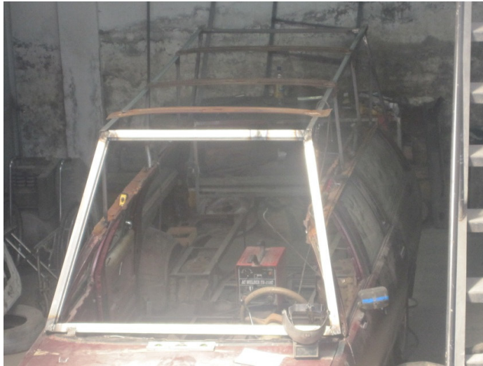
Figura 4.19. Refuerzos Estructura Techo
