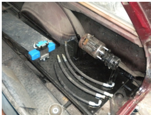
Figura 4.34. Componentes Sistema Hidráulico
