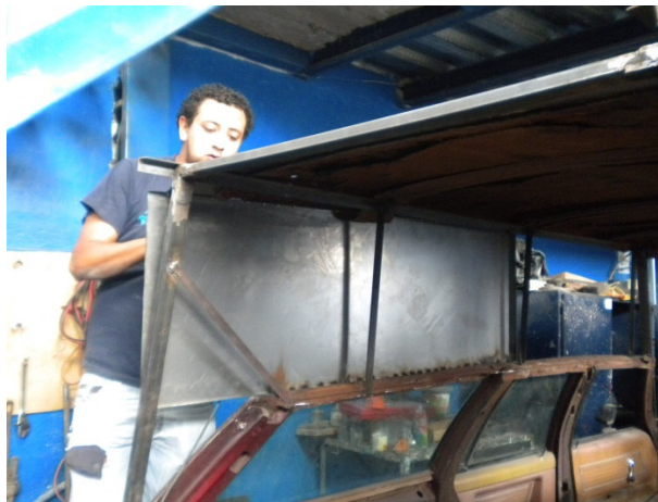
Figura 4.50. Instalación de Paneles Laterales.
