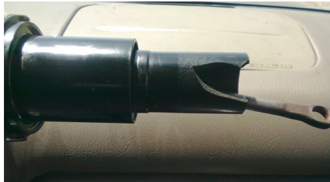
Figura 2.4. Daño en el Cuerpo de Válvula
