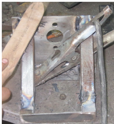
Figura 3.12. Soldadura de refuerzos
