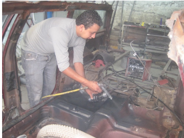
Figura 4.24. Aplicación Recubrimiento Piso Original.
