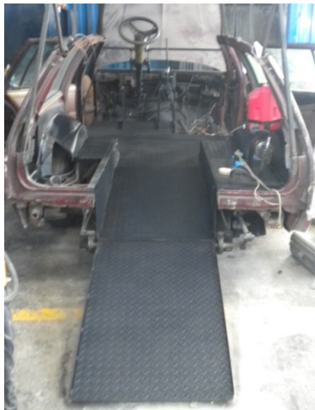
Figura 4.44. Plataforma de acceso terminada
