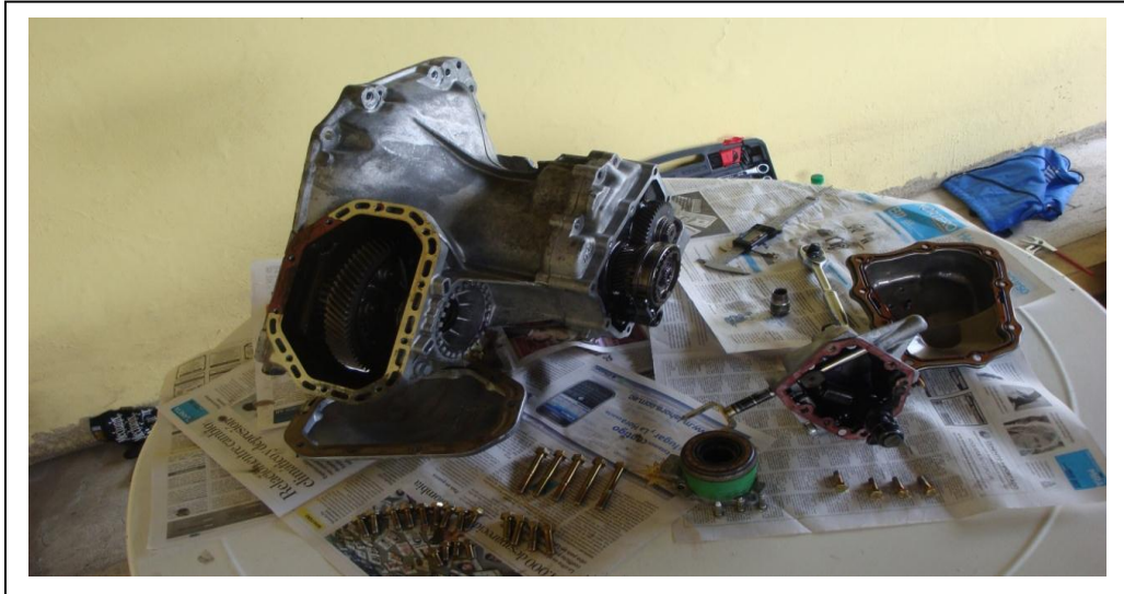
Figura 6.3 Desmontaje de pernos de sujeción de la carcasa
