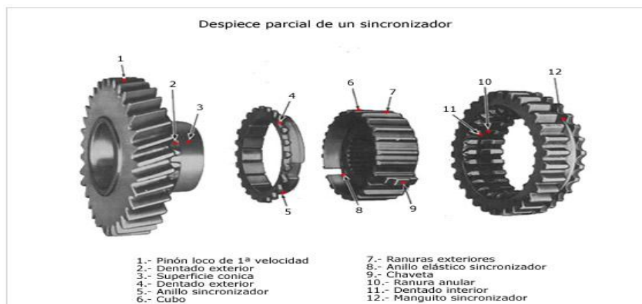
Figura 1.18: Despiece parcial de un sincronizador 23
