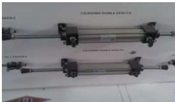
Figura 4.2: cilindro doble efecto
