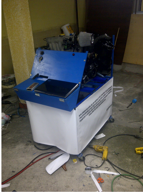
Figura 3.7 Instalación de Lona y montaje de Láptop y ECU. 28
