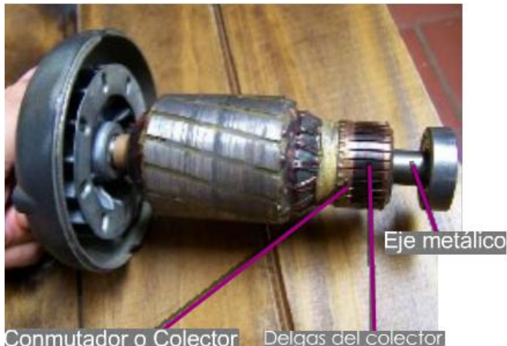
Figura 3.4. Partes electromagnéticas de un motor eléctrico.
