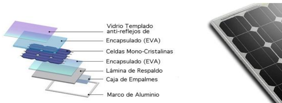
Figura 3.25. Partes de un panel Solar. 19
