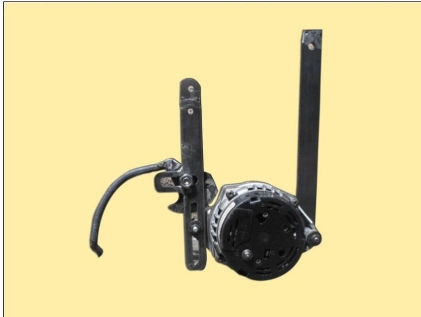
Figura 4.2. Adaptación de barras del alternador lado posterior.
