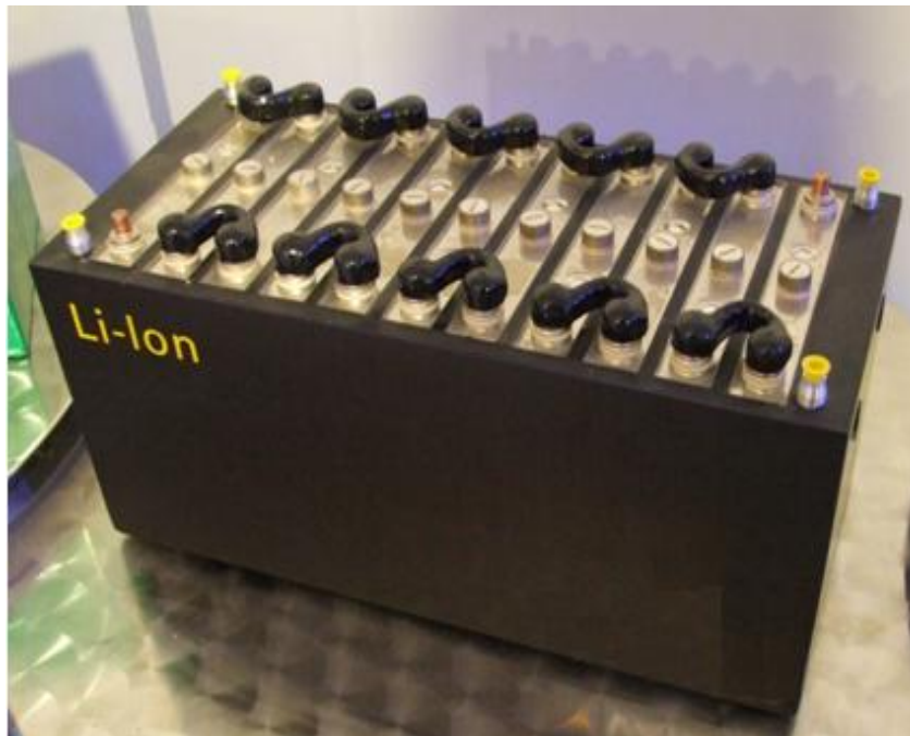
Figura 3.16. Acumulador de Litio 14
