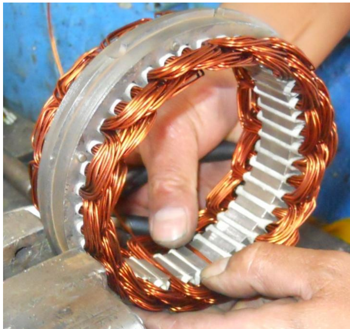
Figura 3.37. Verificación de Bobinado.
