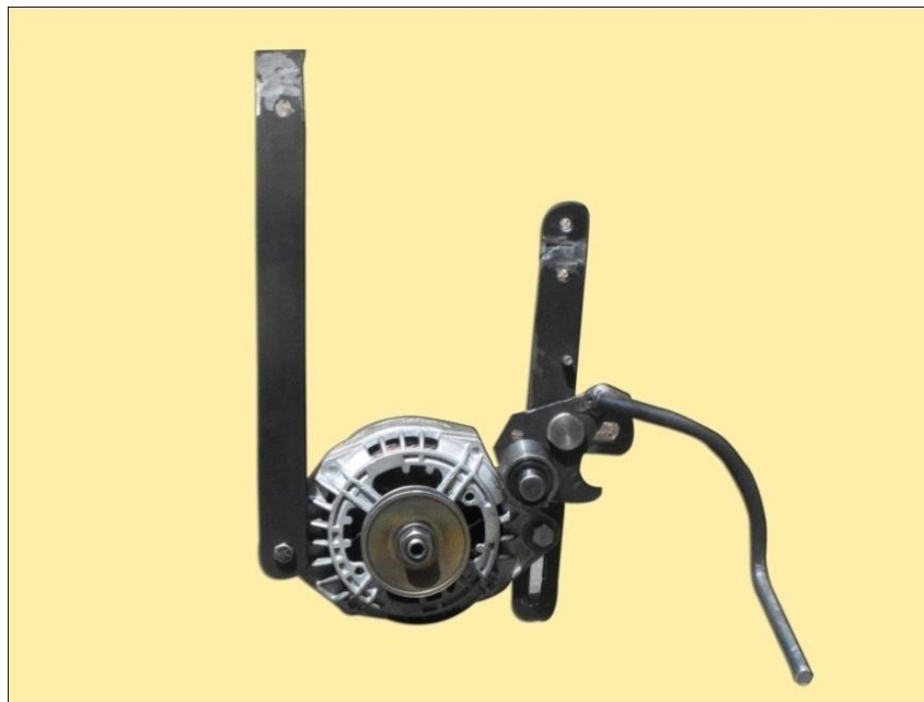
Figura 4.3. Adaptación de barras del alternador lado frontal.
