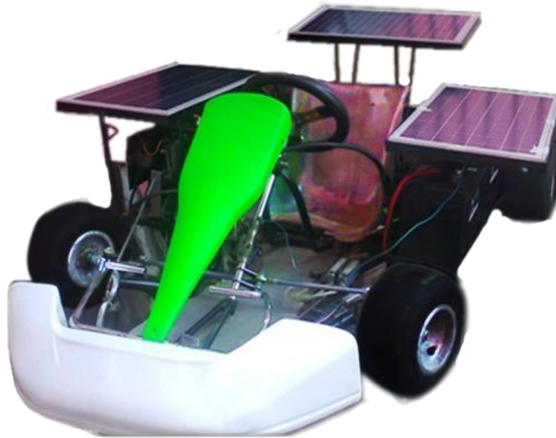
Figura 4.8. Sistema de carga de paneles solares montado.
