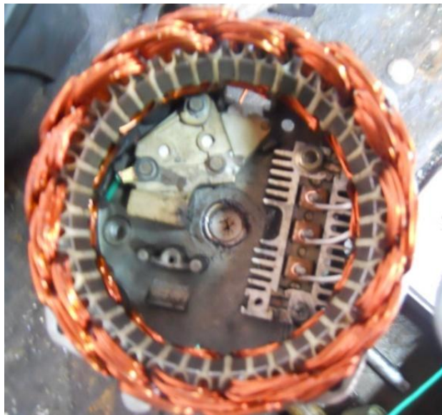
Figura 3.39. Sujeción de los cables de fases.
