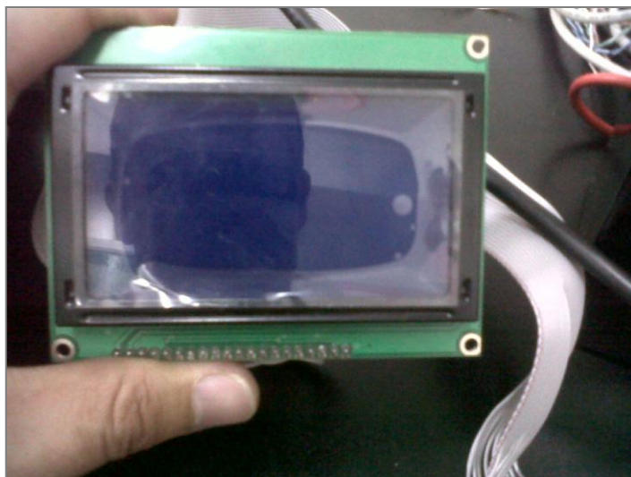
Cap.2 - fig. 19: GLCD 128x64
