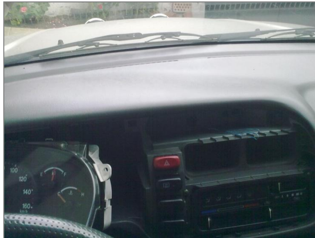
Cap.4 - fig. 2: Retiro de protector y tablero
