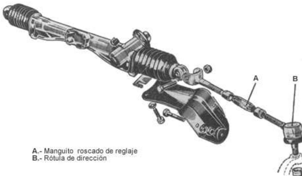
**Figura 1.17 Sistema de Reglaje de la Dirección<sup>20</sup>**
