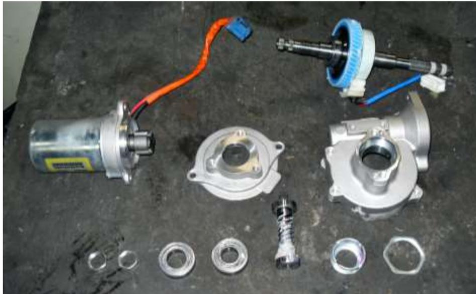
**Figura 4.7 Despiece de la Dirección Electroasistida**
