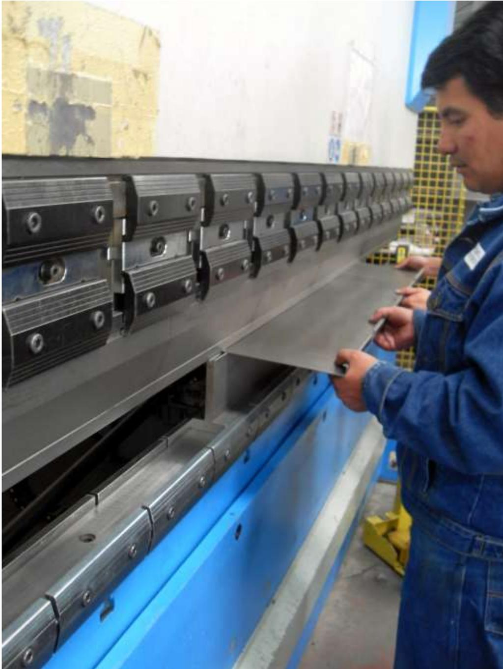
**Figura 4.54 Doblado de la plancha en una prensadora**
