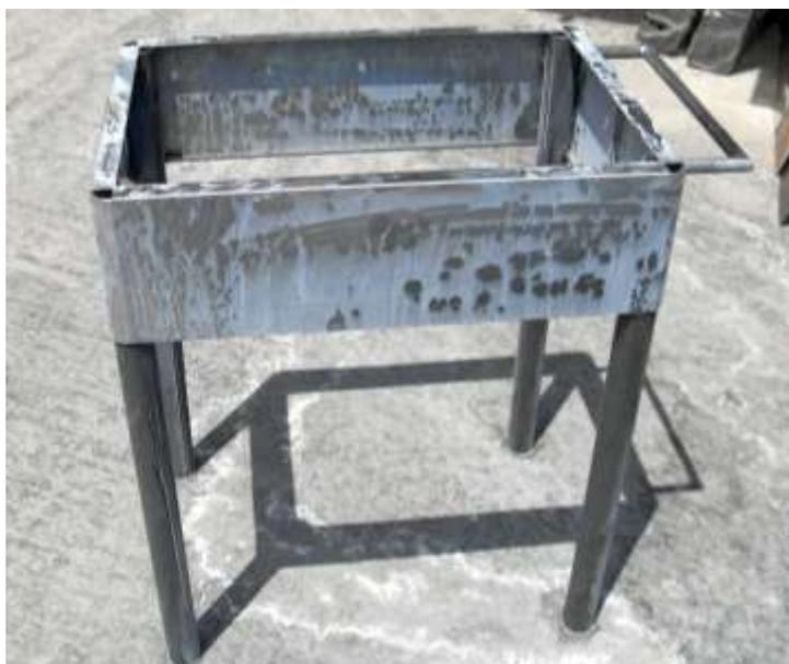
**Figura 4.58 Mesa después del Baño de Fosfato**
