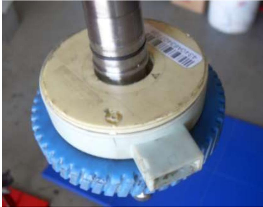
**Figura 4.19 Vista Superior de la Sensor de Torque**
