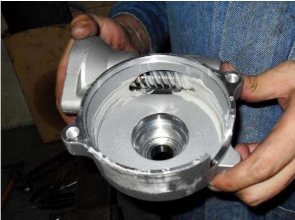
**Figura 4.4 Carcasa del Sistema**
