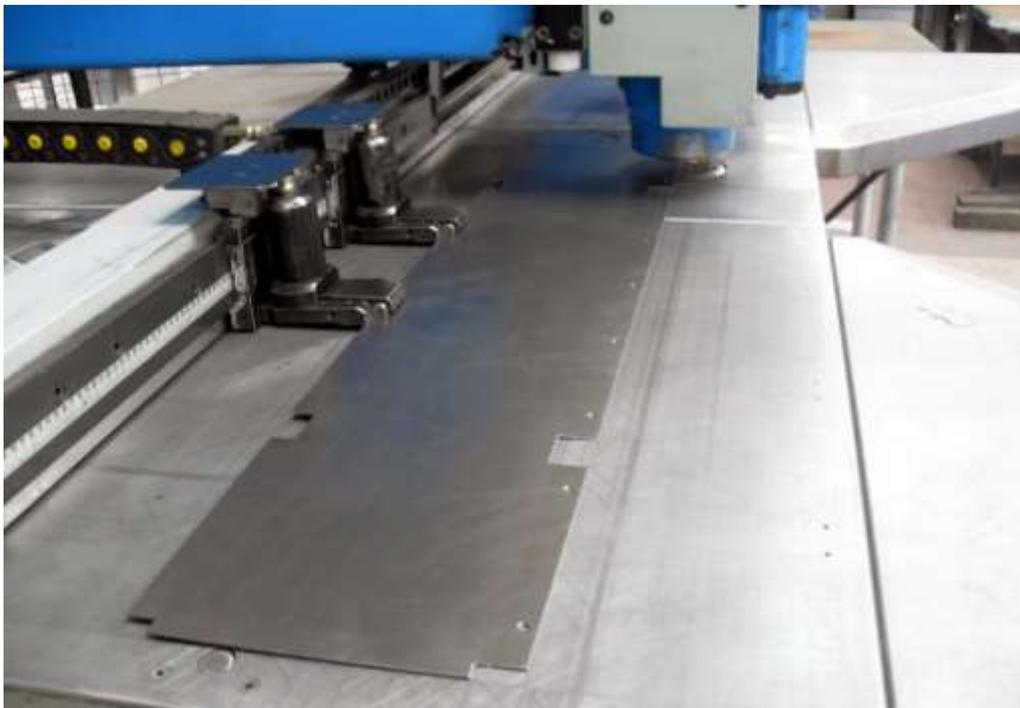
**Figura 4.53 Plancha para formar el costado del tablero**
