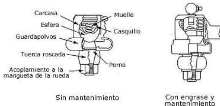
**Figura 1.8 Esquema Interno de las Rótulas de Dirección<sup>10</sup>**
