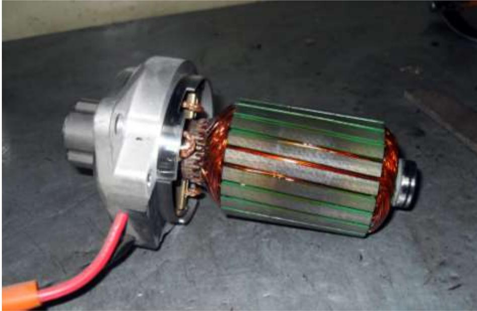
**Figura 4.9 Rotor del Motor Eléctrico**
