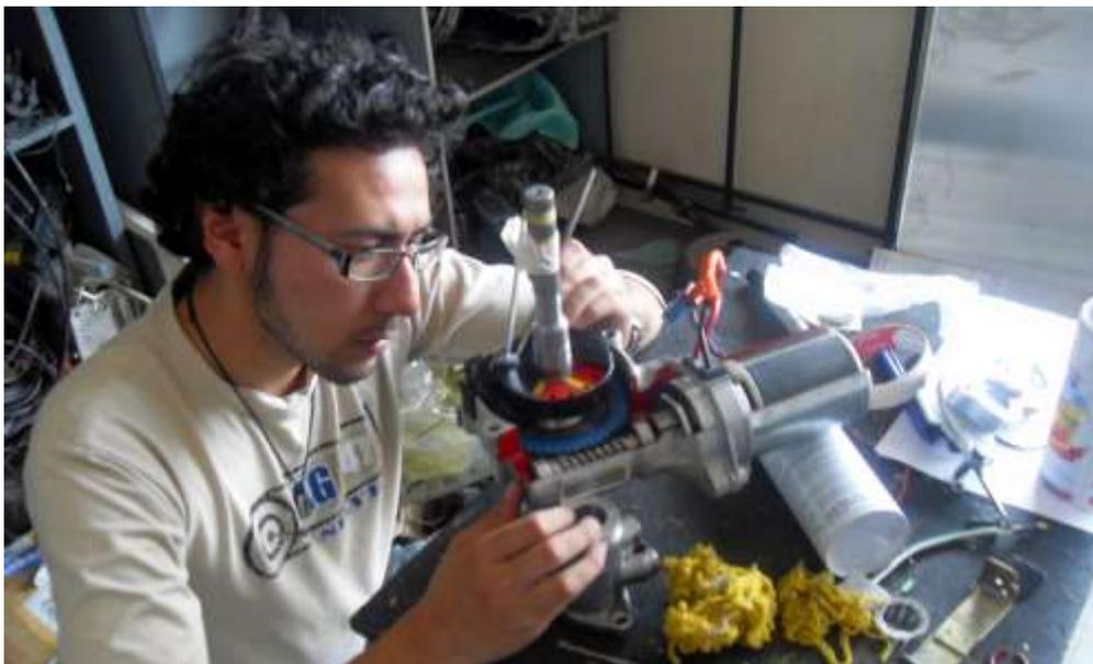
**Figura 4.48 Aseguramiento del Led Emisor con Silicona**
