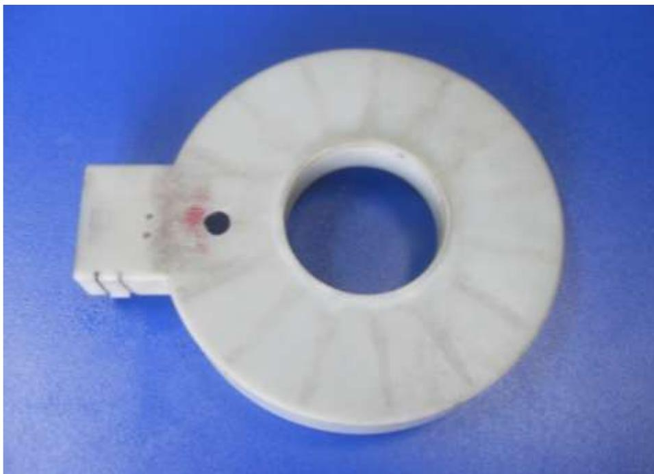
**Figura 4.26 Carcasa del nuevo Sensor con perforación**
