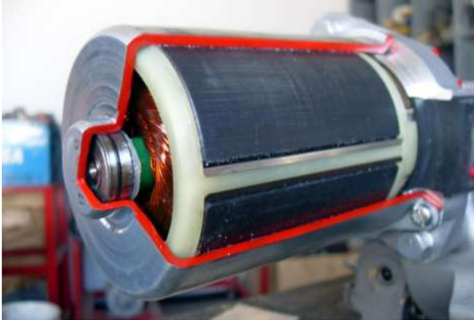
**Figura 4.14 Pintado de la Carcasa del Motor Eléctrico**
