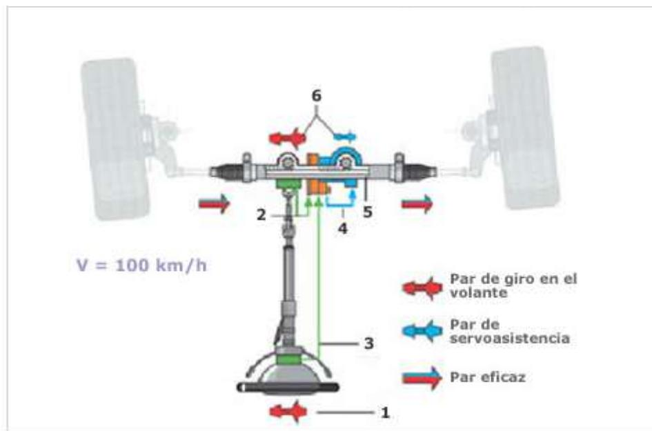
**Figura 2.7 Funcionamiento de la Dirección en Autopista<sup>36</sup>**
