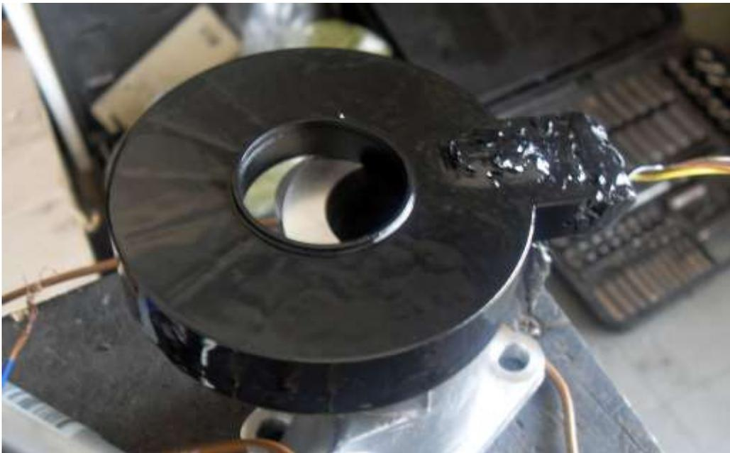
**Figura 4.44 Carcasa del Sensor pintada con Spray Negro**
