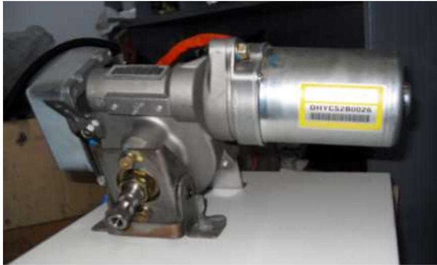
**Figura 4.1 Sistema de Dirección Electroasistida**
