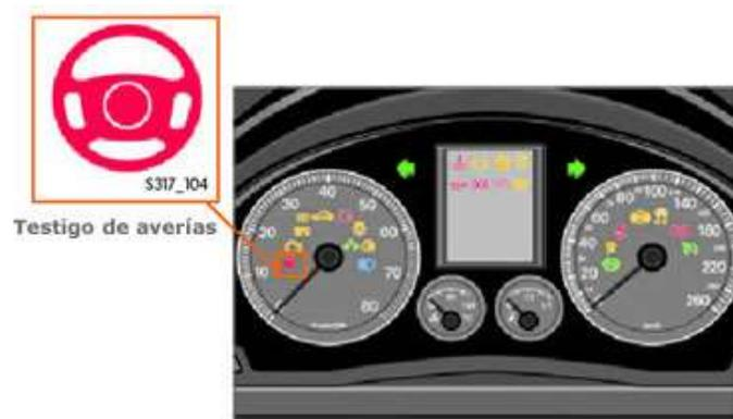
**Figura 3.14 Testigo de Averías de la Dirección Electroasistida<sup>66</sup>**
