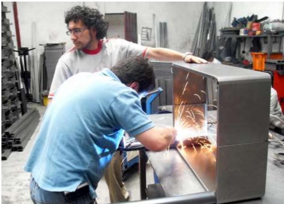
**Figura 4.56 Fijación con suelda Mig de las patas de la mesa en la plancha**
