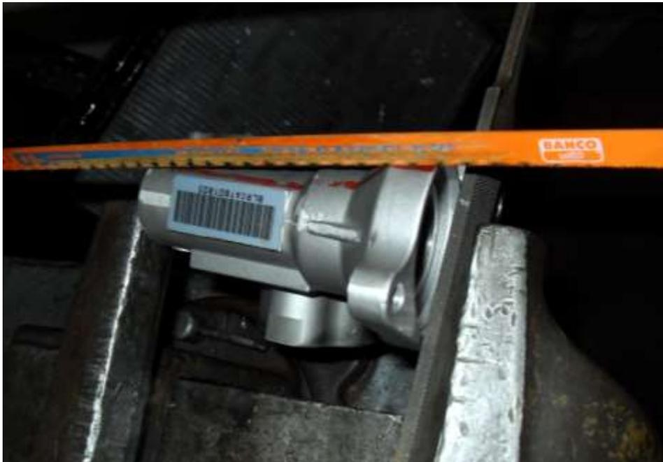
**Figura 4.10 Señalización del corte**
