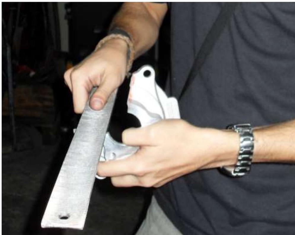
**Figura 4.13 Limado de la carcasa**
