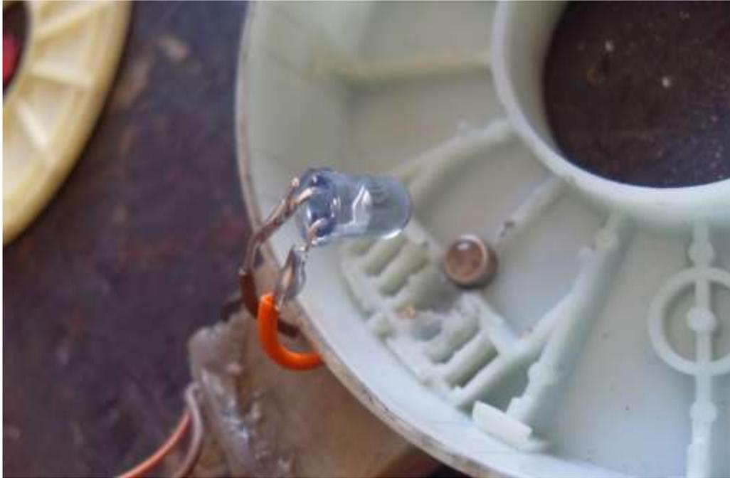
**Figura 4.43 Diodo Emisor y Fototransistor**
