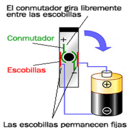
Figura 3.20. Esquema de un motor eléctrico en conexión con una fuente. 1
