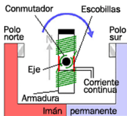
Fig.ura 3.19. Esquema interno de un motor eléctrico. 1
