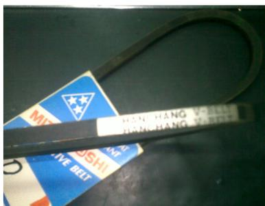
**Figura: 1.14** Correa del Ventilador
