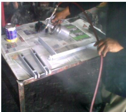
**Figura: 3.41** Aplicación de la pintura sobre soportes de sujeción y travesaño
