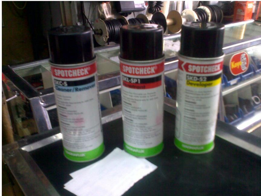
**Figura: 1.17** Tintas penetrantes (limpiador, penetrador, revelador)
