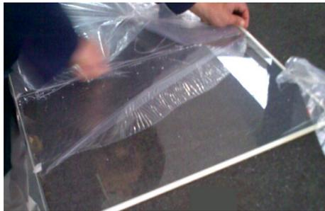
**Figura: 3.34** Unión de las tapas del tanque con cloruro de metileno
