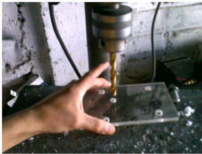
**Figura: 3.10** Perforación de tapas laterales
