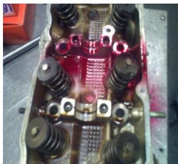
**Figura: 3.66** Rociado con el spray penetrador
