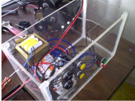
**Figura: 3.58** Ubicación del circuito eléctrico en la caja máster
