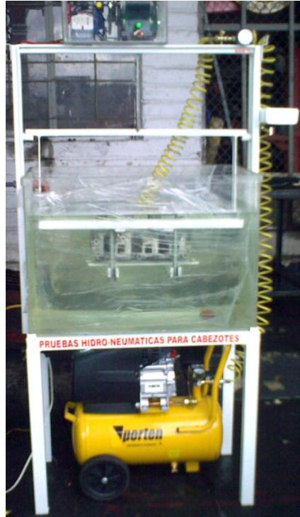
**Figura: 3.63** Comprobador de fisuras
