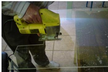
**Figura: 3.32** Corte del acrílico según el diseño
