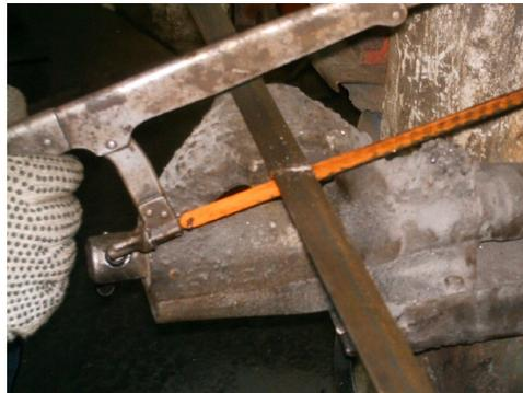
**Figura: 3.29** Corte del cajón porta tintas
