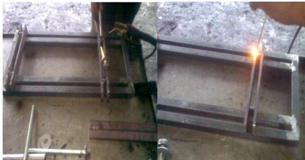
**Figura: 3.5** Medición y Soldadura de Soportes de ajuste de la culata
