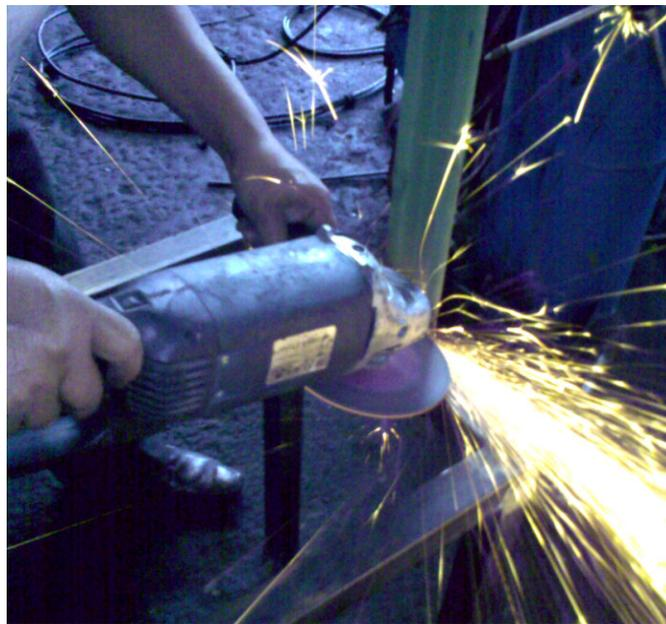
**Figura: 3.27** Desbaste de aristas vivas de la estructura del banco
