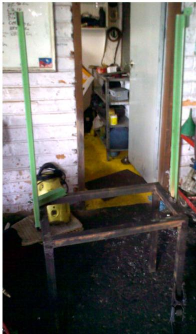
**Figura: 3.23** Columnas unidas mediante suelda
