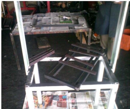
**Figura: 3.39** Fondeado de la estructura metálica
