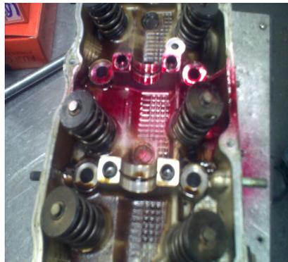
**Figura: 1.19** Culata con tinta penetrante de control de fisura
