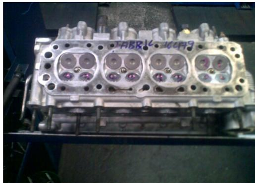
**Figura: 1.1** Prueba de Hermetización
