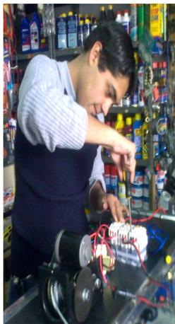
**Figura: 3.53** Conexión del contactor máster al motor eléctrico
