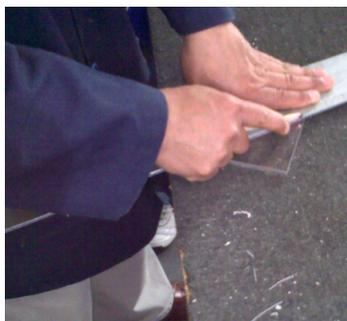
**Figura: 3.8** Corte en acrílico de tapas laterales de la culata
