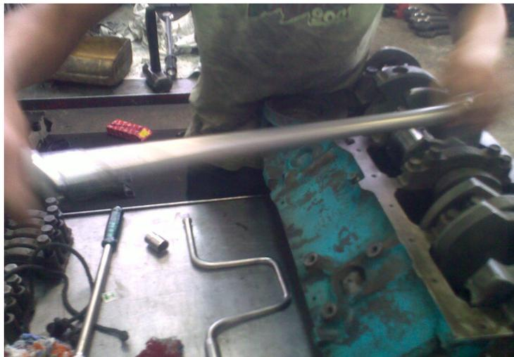
**Figura: 1.5.** Torque en pernos de culata
