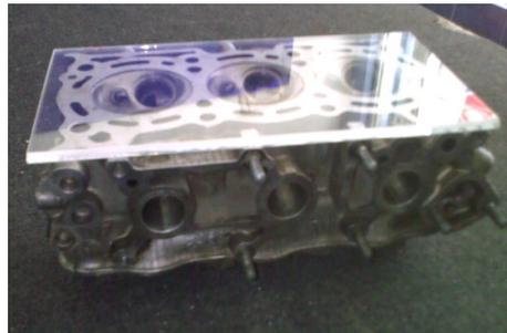
**Figura: 3.7** Tapa superior de culata terminada
