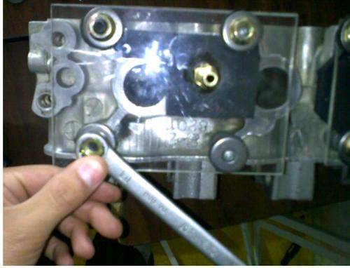
**Figura: 3.12** Apriete del acrílico contra la fibra celulosa
