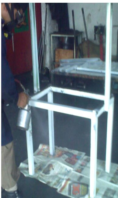
**Figura: 3.42** Aplicación de pintura sobre la estructura metálica
