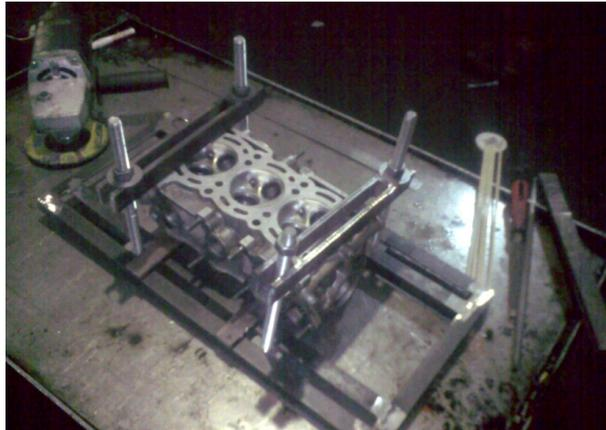
**Figura: 3.14** Soporte y tapas de culata terminados
