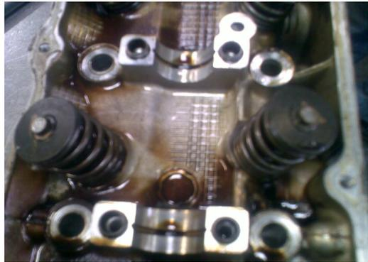
**Figura: 1.18** Culata con tinta penetrante de limpieza
