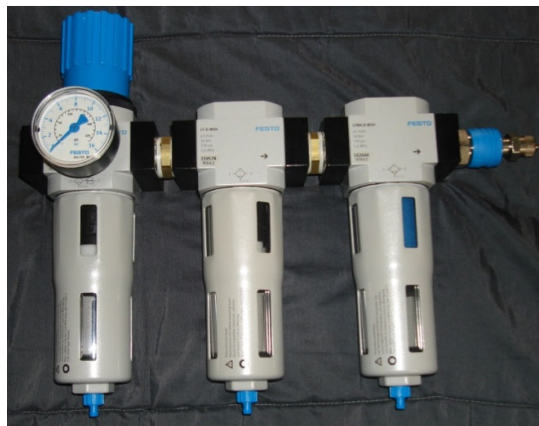
Fig. 4.3, Sistema de filtrado de aire.
