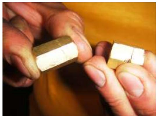
**Fig. 5.3 Niplos con Fisuras**
