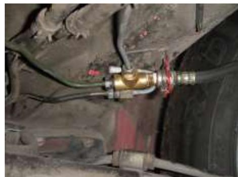
Fig. 2.7 Unión entre cañerías
