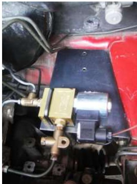
Fig. 3.7 Ubicación de la válvula dentro del vehículo
