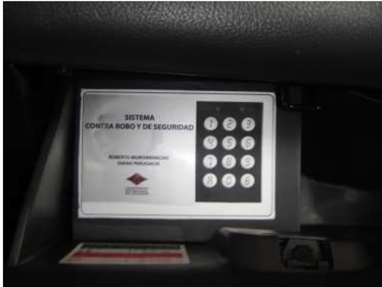
Fig.4.8 Teclado utilizado para la desactivación del sistema
