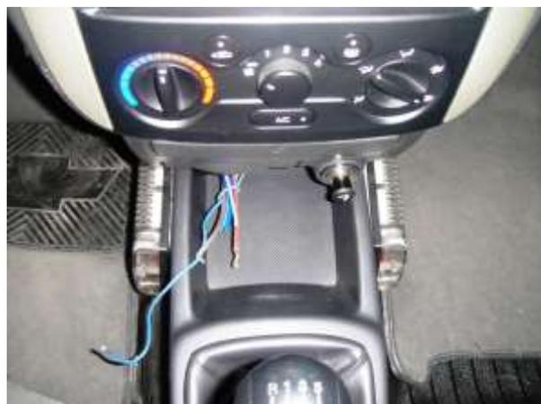
Fig. 4.5 Cableado requerido para la conexión de la PLC
