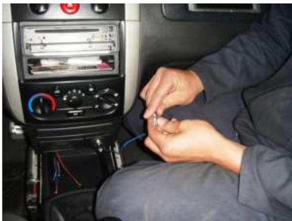
Fig. 4.6 Procedimiento de conexión de los cables hacia la PLC
