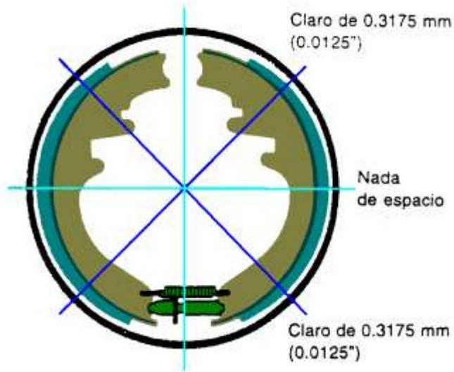
Fig. 1.30 Recorrido de las zapatas de freno
