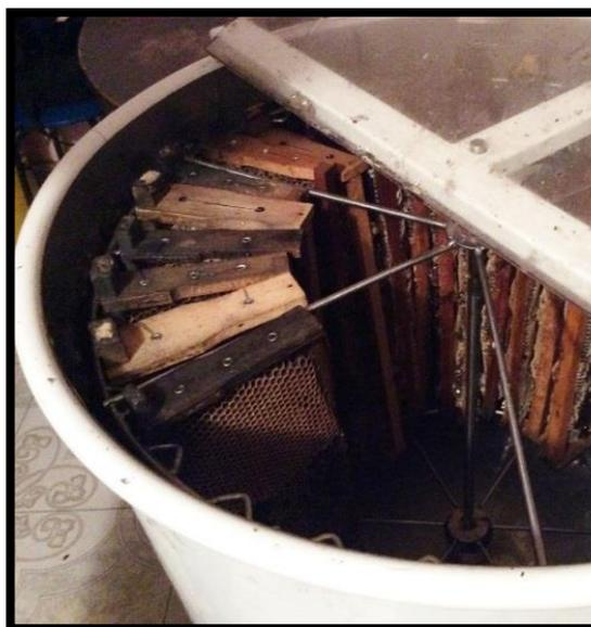
FOTOGRAFÍA 73: Cuadros en máquina de centrifugación.
