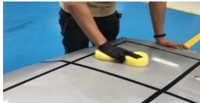
Figura 5 Aplicación de tratamiento cerámico.
