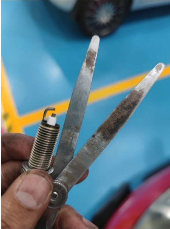
Calibración bujía (1.1mm)
