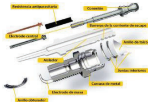
FIGURA 1.14. Componentes de la bujía. 24
