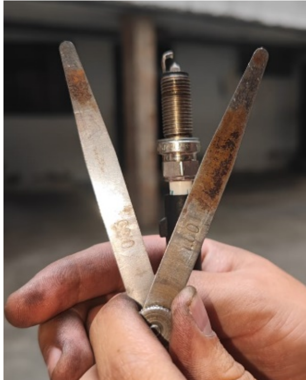
Ilustración 1 Calibración bujía (1.65mm)
