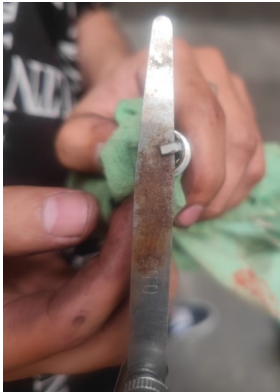
Calibración bujía (0.55mm)
