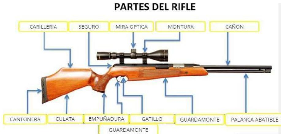
Ilustración 54.- Partes de un Rifle. Recuperado de: <https://t.co/BD2YF79pwg>
