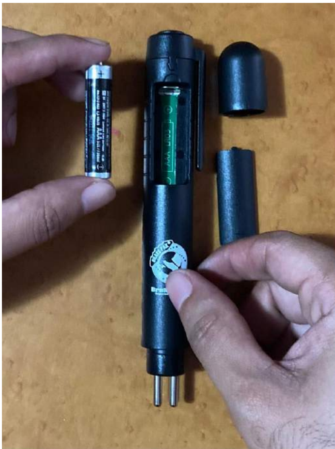
Energización del Probador de Líquido de Frenos
