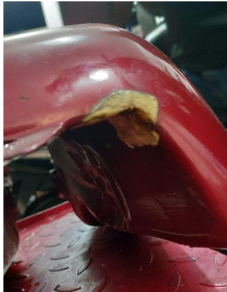
Tanque de Combustible Fisurado
