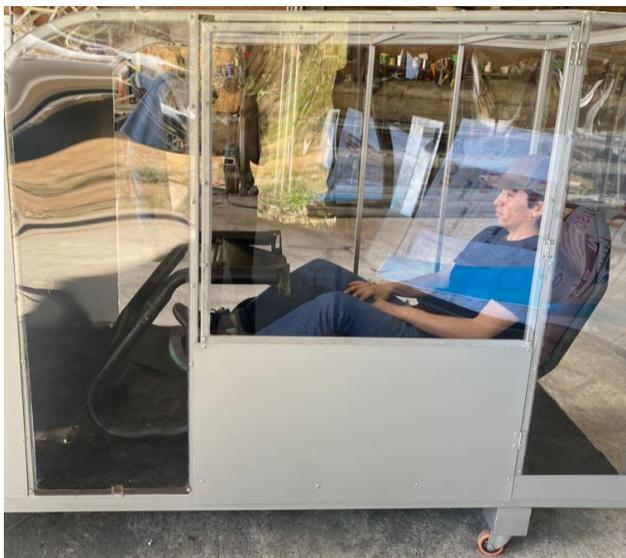
Desde la vista lateral externa se puede observar que, el piloto se encuentra cómodo y relajado para la simulación. El técnico es el encargado de regular la presión alta o baja a la cual se someterá el piloto. El piloto de carrera automovilística refiere que la cabina es aislada, de manera uniforme, y adaptable a su situación. El asiento es cómodo, flexible y se ajusta al tamaño del piloto, para que la simulación sea personalizada y lo más real posible.
