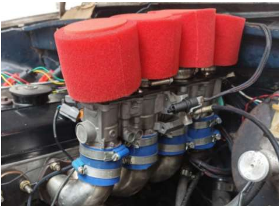
Instalación de Filtros de Aire
