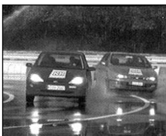
La homologación de una referencia de pastilla para pasar el Reglamento 90, se debe de realizar tanto con pruebas en el laboratorio como con el propio vehículo. Cada referencia de pastilla debe de ser homologada en el vehículo en el que se han de montar, con el vehículo sensorizado, es decir, debemos de saber a
