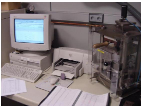
Usando una máquina de compresibilidad se comprueba el valor que presenta la pastilla tanto en caliente como en frío. La compresibilidad de la pastilla es una característica importante del material de fricción ya que el material debe de ser compresible para conseguir una buena adaptación en el disco, es decir, que
