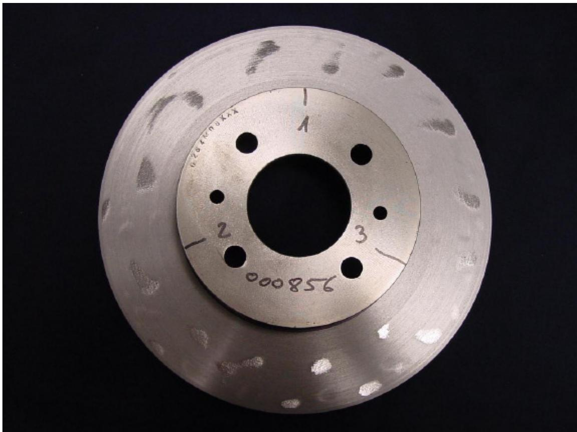
Transformación del material del disco. El disco de la imagen está rectificado y aún así las manchas provocadas por el "hot judder" no se eliminan.
