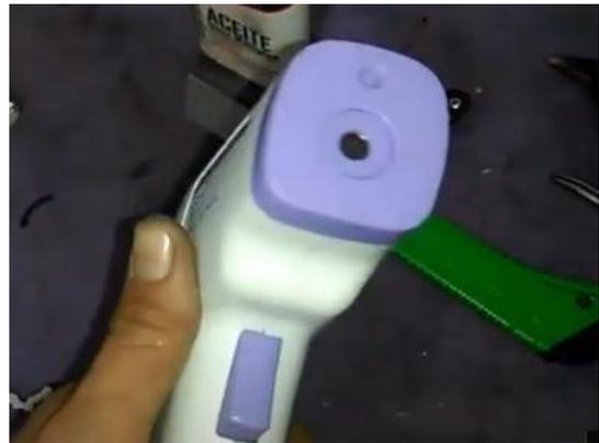
Figura 15. Medidor de temperatura infrarrojo
