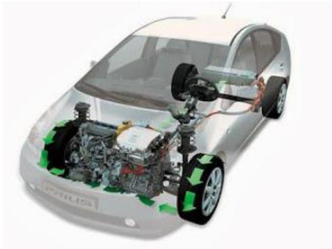
*Ilustración 32 Esquema de frenado regenerativo [14]*
