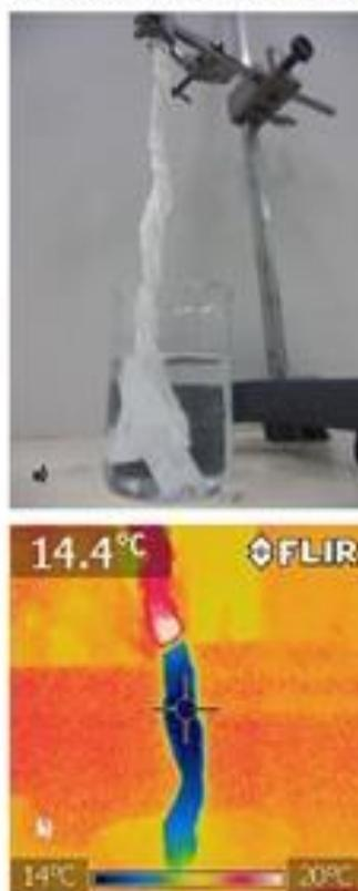
Figura 5. Imagen estática (a) y térmica (b) del proceso de la capilaridad de una tira de papel sumergida en agua: evaporación total y condensación del agua (esta última y roja).
