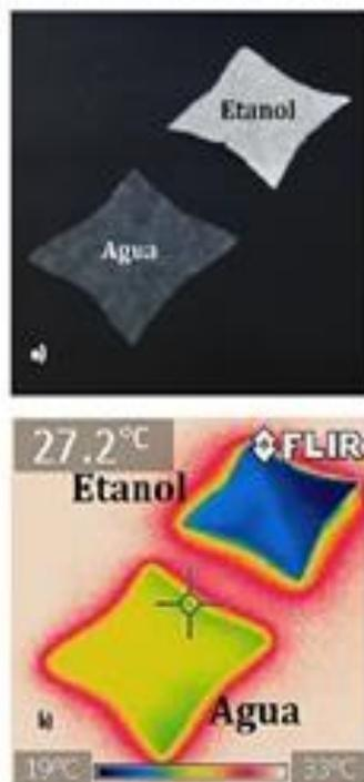
Figura 4. Imagen estática (a) y térmica (b) comparativa ante la evaporación del agua y el etanol.
