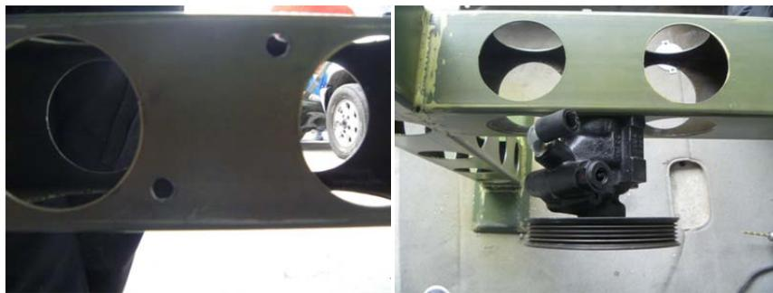
**Figura 4.28 Ubicación de la bomba de dirección hidráulica.** <sup>43</sup>
