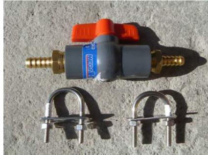
**Figura 4.43 Reductor de flujo.**<sup>55</sup>
