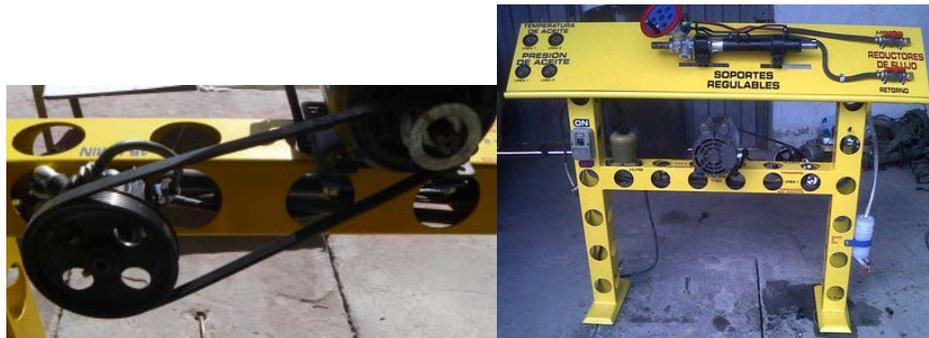
**Figura 5.6 Poleas y banda aseguradas.**
