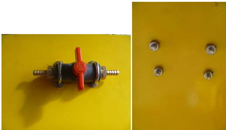
**Figura 4.45 Reductor de flujo instalado.**
