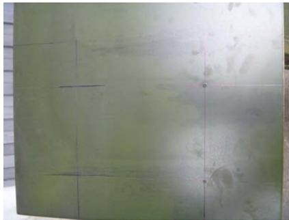
**Figura 4.30 Marcas de ubicación para los manómetros e indicadores.**<sup>45</sup>
