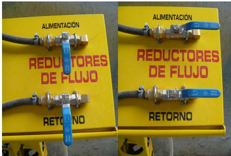
**Figura 5.25 Reductores de flujo alimentación y retorno (20%)**
