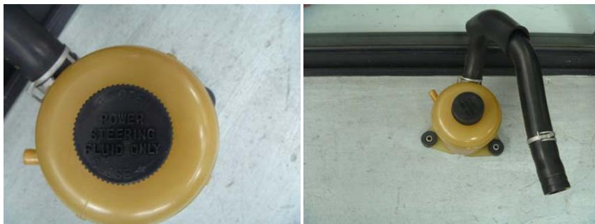
**Figura 4.26 Depósito de líquido hidráulico.<sup>41</sup>**
