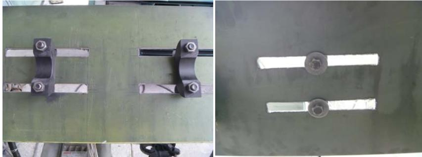
**Figura 4.36 Instalación de los soportes de caja de dirección hidráulica.<sup>49</sup>**
