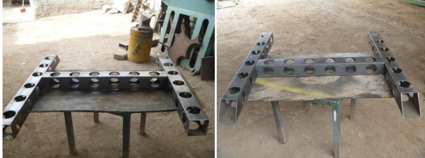
**Figura 4.19 Suelda de pilares y templador de la estructura**
