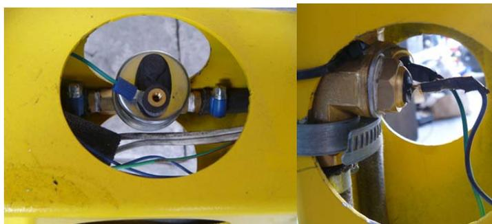
**Figura 4.58 Conexión del cable de señal a los trompos.**<sup>65</sup>
