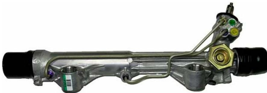
**Figura 3.3 Caja de dirección hidráulica.** <sup>23</sup>
