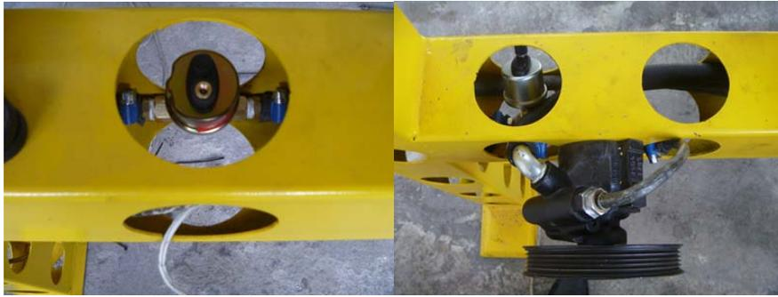
**Figura 4.50 Trompo de presión de aceite.**
