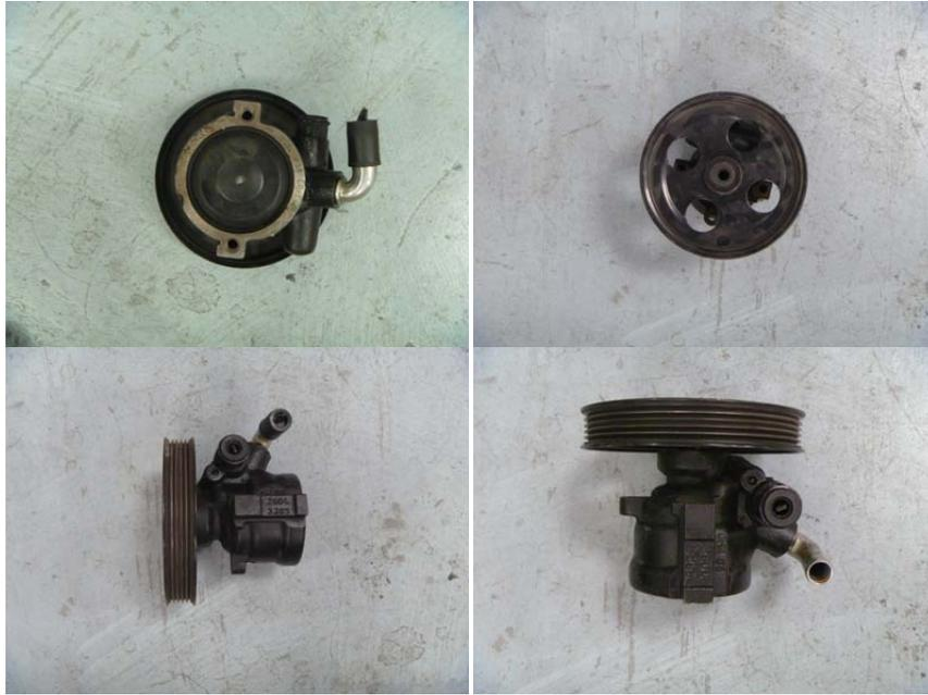
**Figura 4.16 Bomba de dirección hidráulica.<sup>35</sup>**
