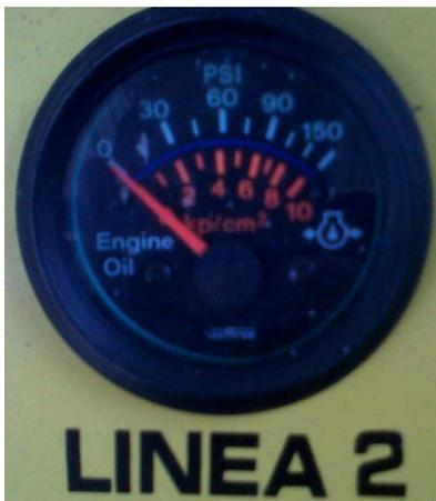
**Figura 5.9 Manómetro de presión de aceite Línea 2 (Retorno)**
