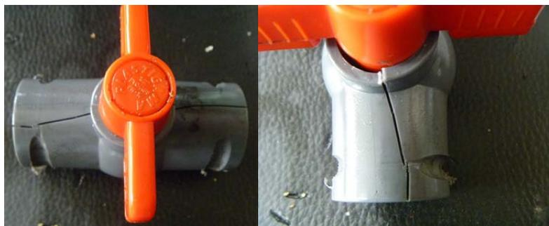
**Figura 5.12 Reductor de flujo ROTO.<sup>75</sup>**
