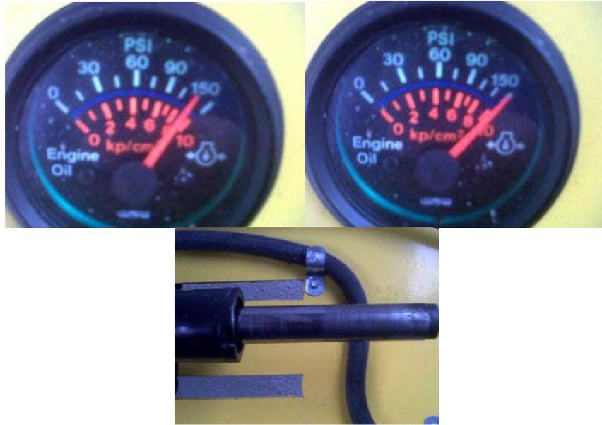
**Figura 5.8 Manómetro de presión de aceite Línea 1 movimiento forzado**
