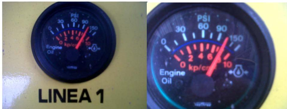
**Figura 5.7 Manómetro de presión de aceite Línea 1 funcionamiento normal (130 PSI).<sup>72</sup>**
