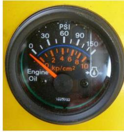
**Figura 4.11 Manómetro de presión de aceite.<sup>30</sup>**
