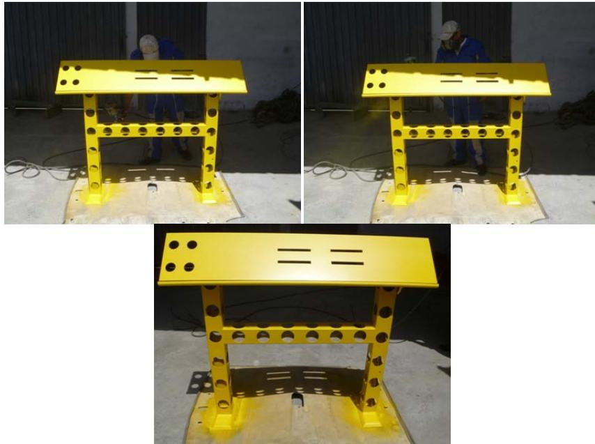
**Figura 4.42 Pintura de la estructura del banco de pruebas.<sup>54</sup>**
