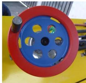
**Figura 4.62 Volante de accionamiento de cajas de dirección hidráulicas.**
