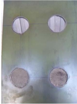
**Figura 4.31 Perforaciones para la ubicación de los manómetros e indicadores.<sup>46</sup>**
