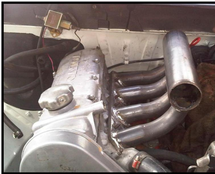
Grafico 3.8 Múltiple de admisión acoplado adaptado en motor VOLVO B21
