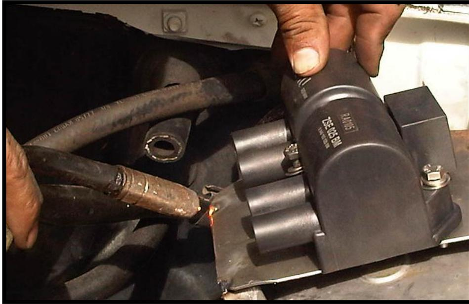
Grafico 3.24 Instalación Base de la Bobina de Encendido
