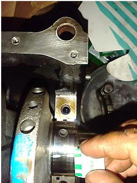
Por consiguiente, no se procede a realizar rectificaciones solo limpieza de las partes y el cambio de chapas de biela y bancada estándar (STD), empaquetadura de motor, bomba de aceite, bujías, aceite motor y filtro motor (ver Figura 41).
