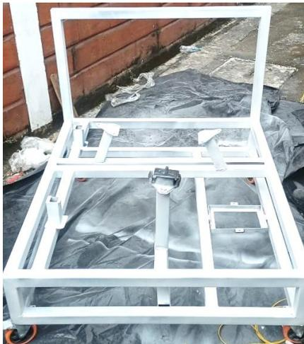
Una vez que se haya completado la aplicación de todo el fondo automotriz en toda la estructura y tras 1,5 horas de secado, se procede con la aplicación de la pintura (código AP159-5). (Ver Figura 30)
