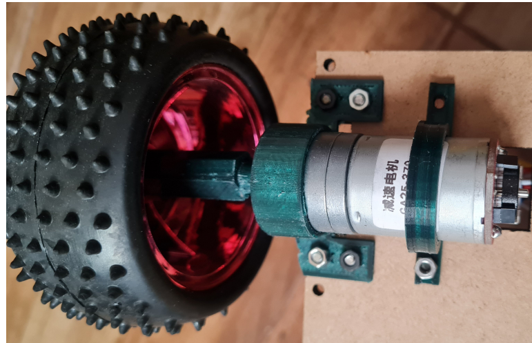
Figura 29. Soporte de motores y llanta posterior.
