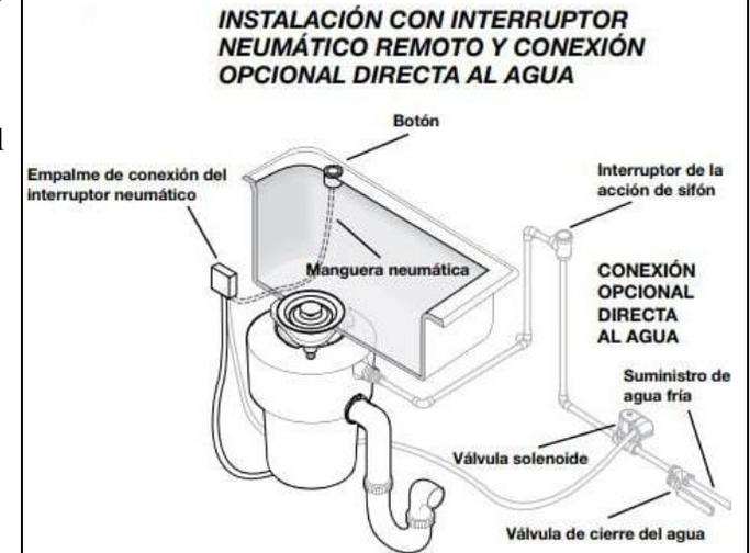
*Ilustración 15 – Instalación Típica de triturador de desechos*
