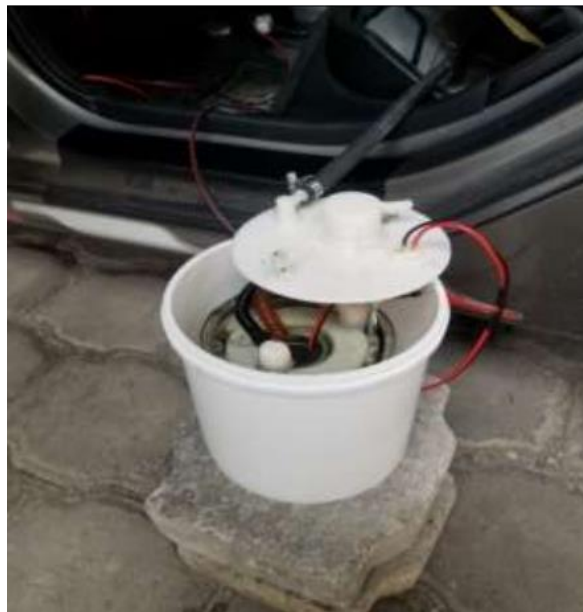
Figura 7-2. Depósito externo de combustible
