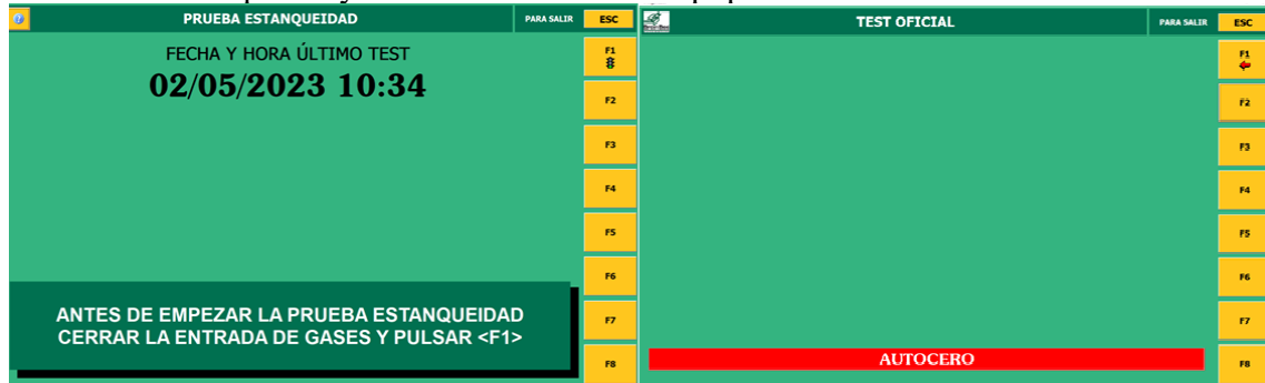
Prueba de estanqueidad y Auto calibración del equipo AGS688
