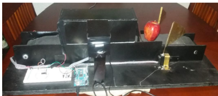
Figura 8. Clasificador de manzanas por color [17].
