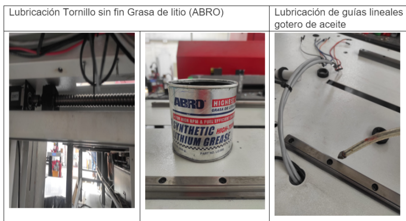
Figura 56. Lubricación elementos subsistema de traslación
