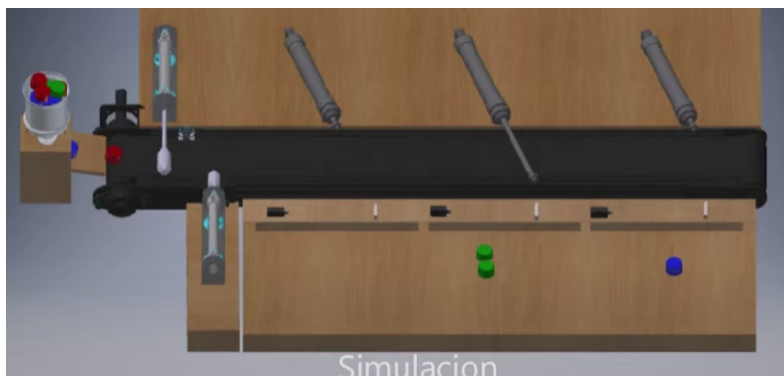
Figura 9. Selector de tapas por color [18].
