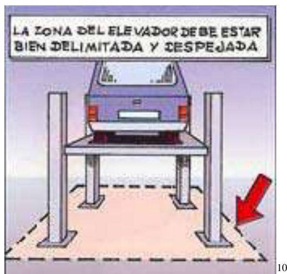
Figura 4.20 Zona del elevador despejada
