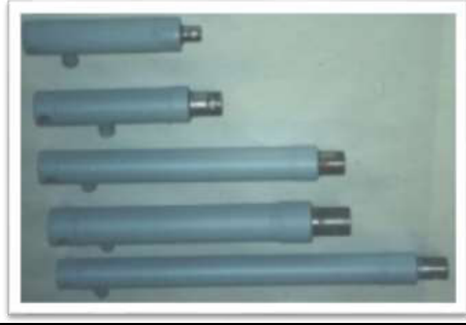
Figura 2.11 Cilindro hidráulico tipo simple efecto
