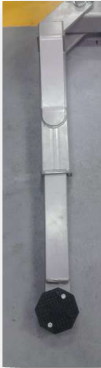
Figura 2.24 Brazo extensible delantero
