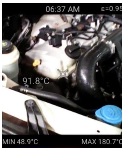
En la figura 24, se aprecia otra toma de datos en el mismo punto del cilindro número uno, pero en modo de imagen térmica.
