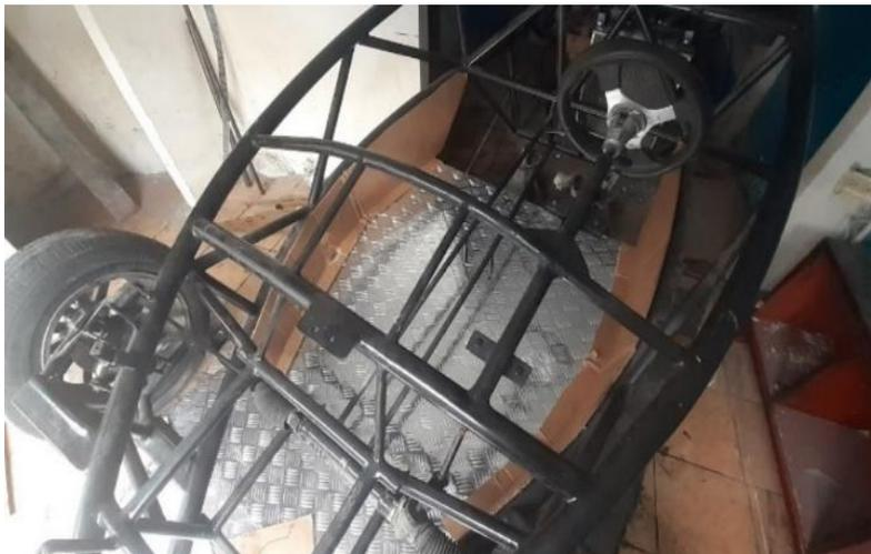
En la Figura 40 se muestra el uso del molde de cartón de los laterales previo al corte, lo cuales sirven de guía al momento de cortar, en este caso se dejó 5 cm extra en la zona de abajo para realizar un doblado en la pieza que permita que encaje y no se mueva.
