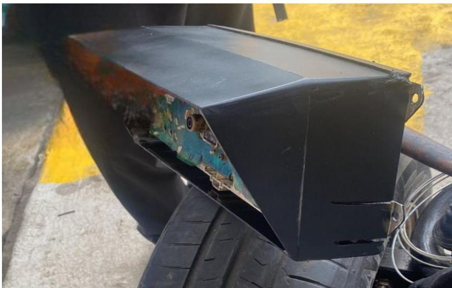
En la parte delantera se utilizó una placa de acrílico transparente la cual se colocó a 90° lo cual le dará más visibilidad al conductor; En la Figura 59 se muestra el resultado de la remodelación de la parte frontal del tablero.
