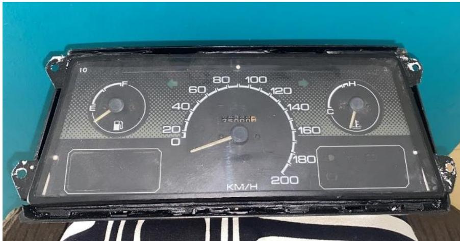
Para la adaptación del tablero en el habitáculo se colocó dos platinas en la parte del en medio del chasis con una inclinación hacia el conductor lo cual le ayudara a que este tenga una buena visibilidad de los datos del vehículo evitando movimientos innecesarios; En la Figura 60 se muestra el tablero instalado dentro del habitáculo.
