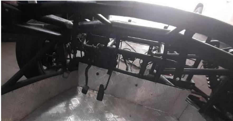
Para realizar el corte de la parte trasera del habitáculo se hizo uso de las medidas previas obtenidas que son 91 x 85 x 38 cm, pero dejando un extra de 5 cm en la parte bajo para realizar un doblado que entre por debajo de la base de piso y le dé más resistencia a la estructura; Como se muestra en la Figura 45 el resultado del corte y colocación de la pieza.
