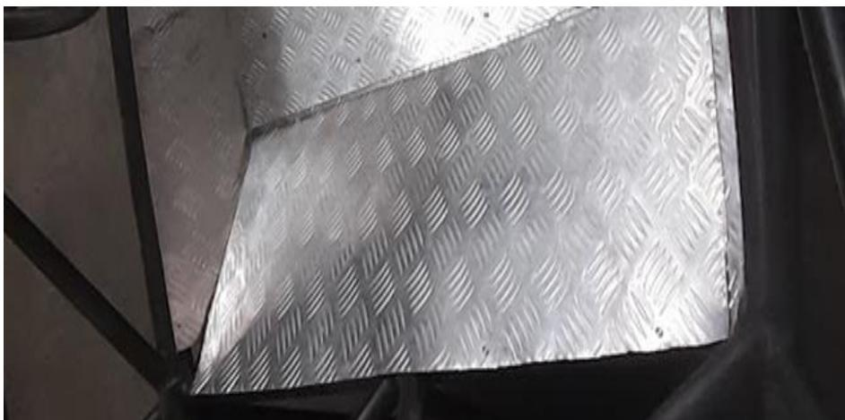
Por último, para asegurar todas las piezas de la base del habitáculo se utilizó remaches y tornillos los cuales ayudan a que la estructura se mantenga firme y unida al chasis tubular; En la Figura 46 se muestra el resultado del habitáculo.
