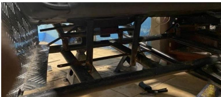
Después de comprobar que tenía visibilidad y que también tenía control de todos los implementos se procedió a soldar la base del asiento al chasis tubular; En la Figura 55 se muestra el resultado de la soldadura de la base de los asientos.
