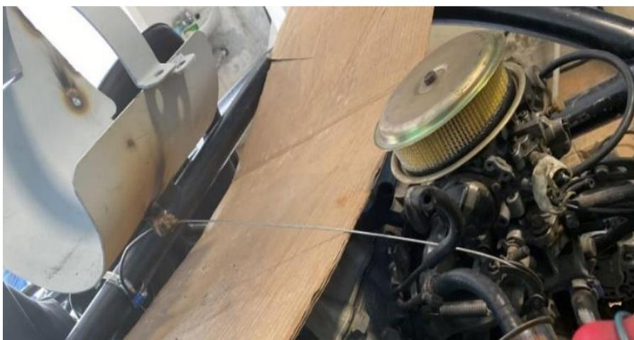
Para el funcionamiento del pedal de embrague se utilizó un cable de embrague de 3.5 metros que conectara la parte trasera con el pedal de embrague, se aseguró el cable con abrazaderas metálicas; En la Figura 51 se muestra el resultado de la adaptación de el embrague.
