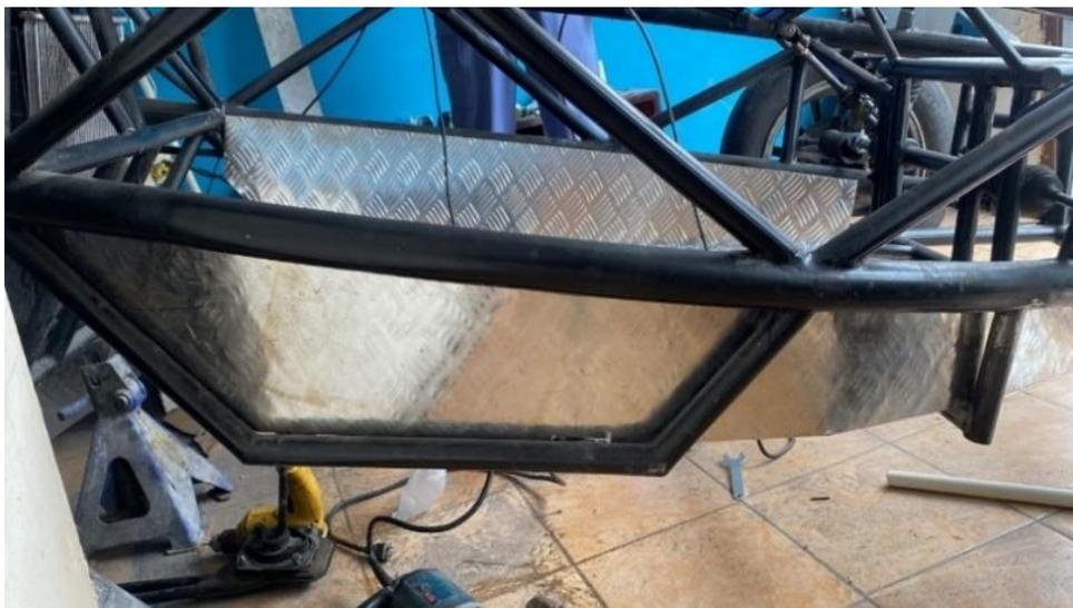
Para realizar el corte de la pieza delantera solo se marcó un rectángulo de 77 x 20 y se realizó el corte con la amoladora, después se realizó su respectiva comprobación dentro del habitáculo interno; Como se muestra en la Figura 44.
