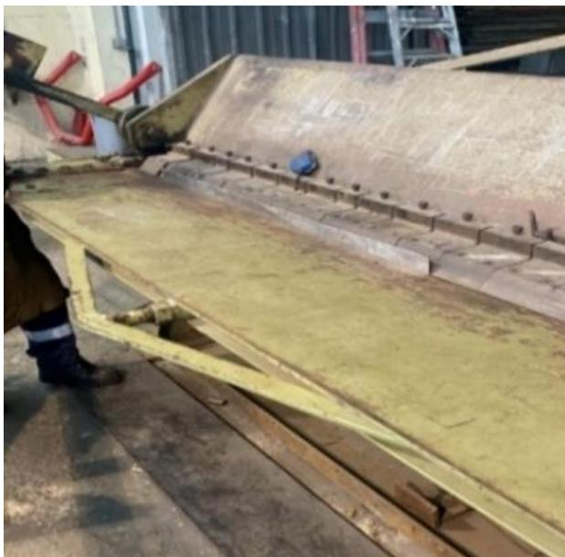
En la Figura 42 se puede ver la zona doblada de 5 cm de las piezas de los laterales el cual quedara debajo de la base del piso dando más rigidez a la estructura.
