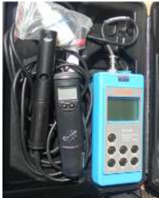
Figura 15.1. Multi-parámetros (izq.) y medidor de oxígeno (der.).
