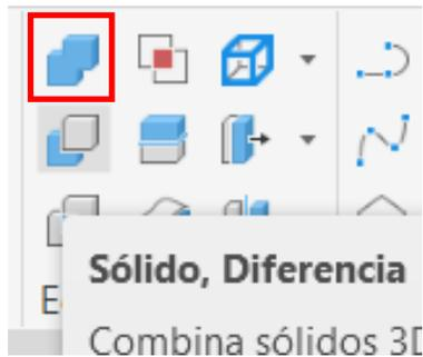
Ejecutamos el comando “DIFERENCIA”, luego seleccionamos el elemento que deseamos mantener y hacemos clic en enter, luego seleccionamos el elemento que usaremos para sustraer y presionamos enter, después de esto veremos que se ha generado una sustracción al elemento inicial, tal como se muestra en la Figura 256.
