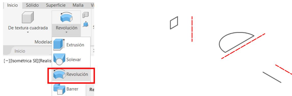
Cuando aplicamos revolución a un elemento podemos insertar los grados que necesitamos, en este caso elegimos  $360^\circ$  para la primera entidad,  $180^\circ$  para la segunda y  $90^\circ$  para la tercera entidad, tal como se muestra en la Figura 240.
