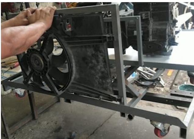
Soporte del Condensador y Electroventilador
