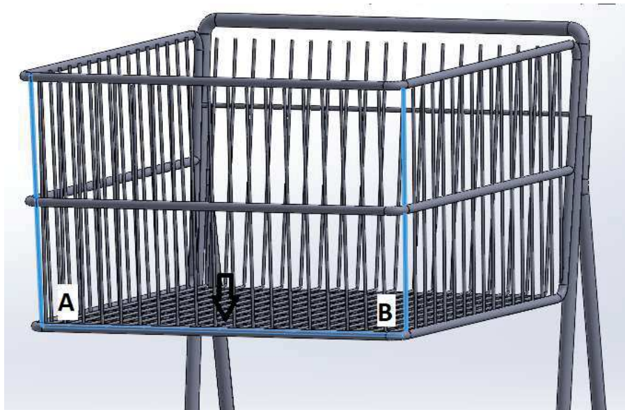
Figura 24: Representación de los apoyos y fuerza de la varilla de la canasta.
