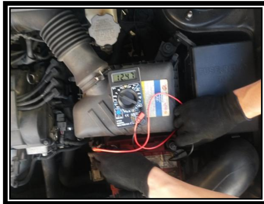
FIGURA 2.3 Medición voltaje batería
