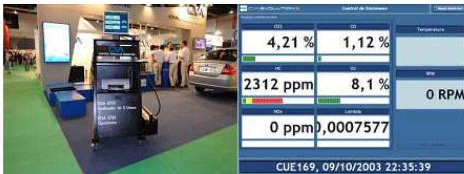
Figura. 3.9. Analizador de gases.
