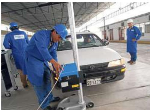
Figura. 3.7. Luxómetro con regloscopio.
