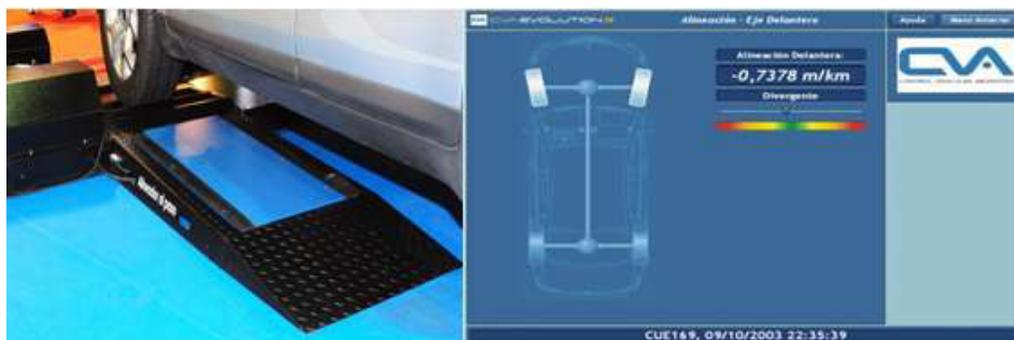
Figura. 3.2. Banco de pruebas para deriva dinámica
