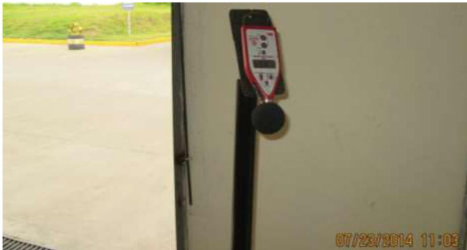
Figura. 3.11. Posición ideal del sonómetro.
