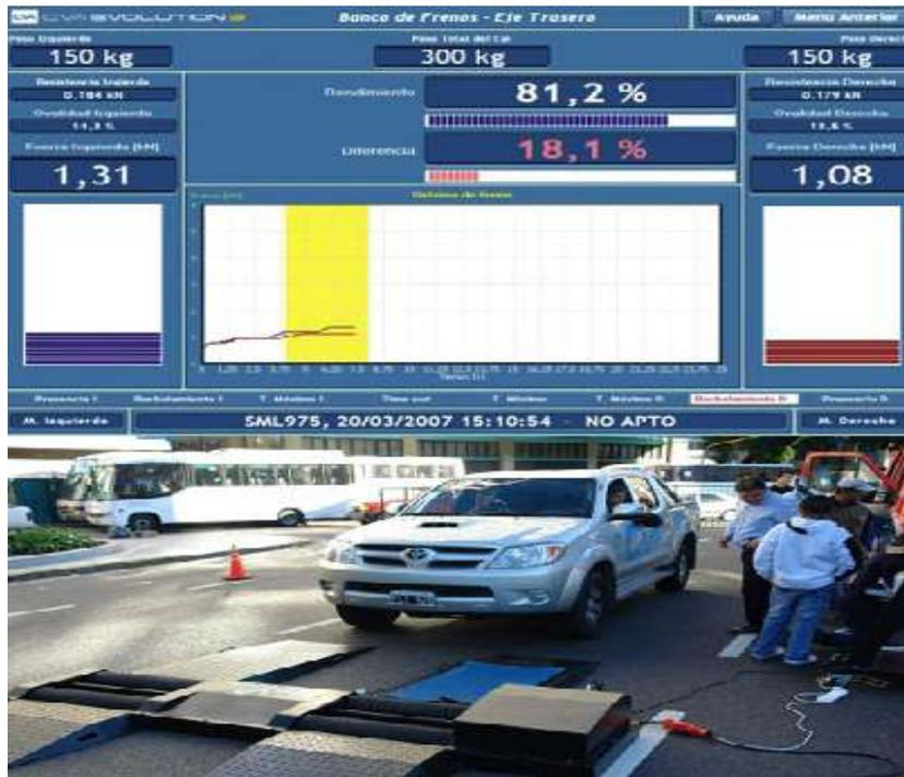
Figura. 3.4. Banco de pruebas para frenos.
