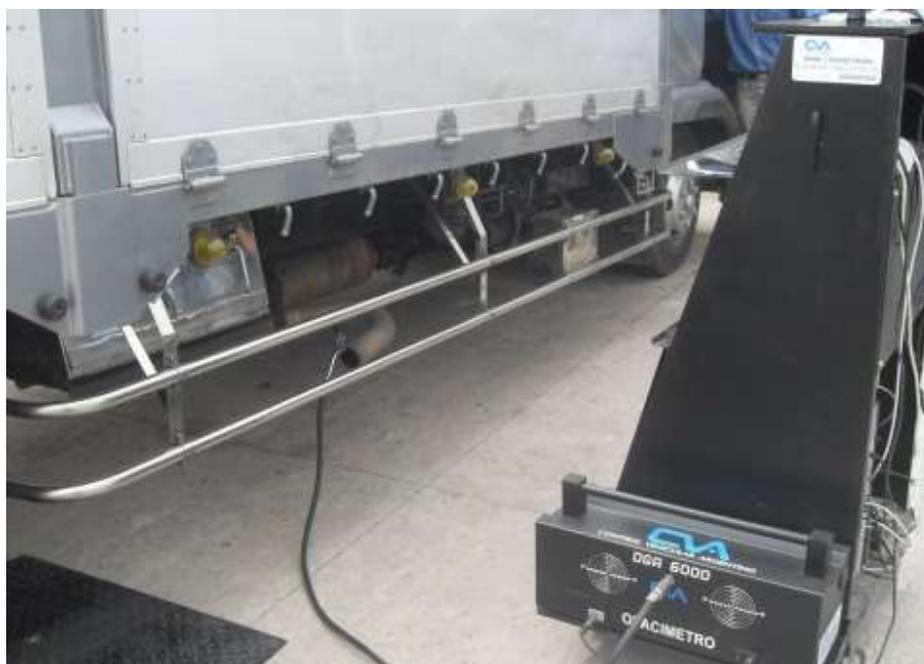
Figura. 3.10. Opacímetro de flujo parcial.
